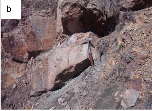
Şekil 3.9. Gurbetyatađı yöresinde yüzeyleme veren kırıntılı kayaçların sahadaki görünümleri (a: Kırıntılı kayaçların tabandan tavana kadar olan genel görüntüsü, b: Kalın tabakalı kumtaşı, c: Kumtaşı, çamurtaşı ardalanması)
