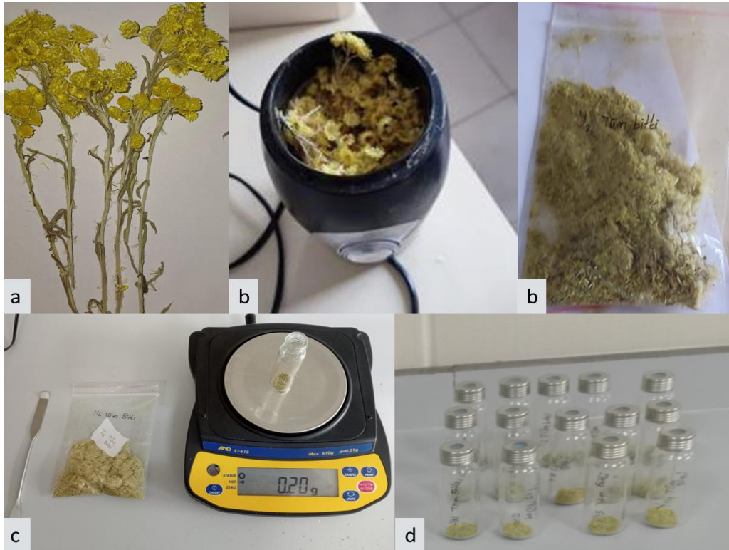
Şekil 11. Altın otu örneklerinin (a) öğütülmesi (b), tartılması (c) ve analiz için tüplere alınmasına (d) ilişkin görünüm
