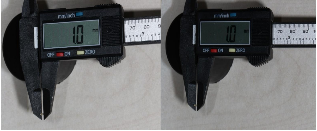
Şekil 3. 11: Elde edilen numunelerin 1x1 mm boyutlarında olduğunun kontrol edilmesi.
