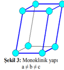
Şekil 4: Zirkonyanın kristallografik yapıları: a: Kübik yapı, b: Tetragonal yapı, c: Monoklinik yapı (50)
