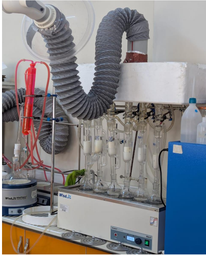
Şekil 22. Yağ tayini (Soxhlet düzeneği)
