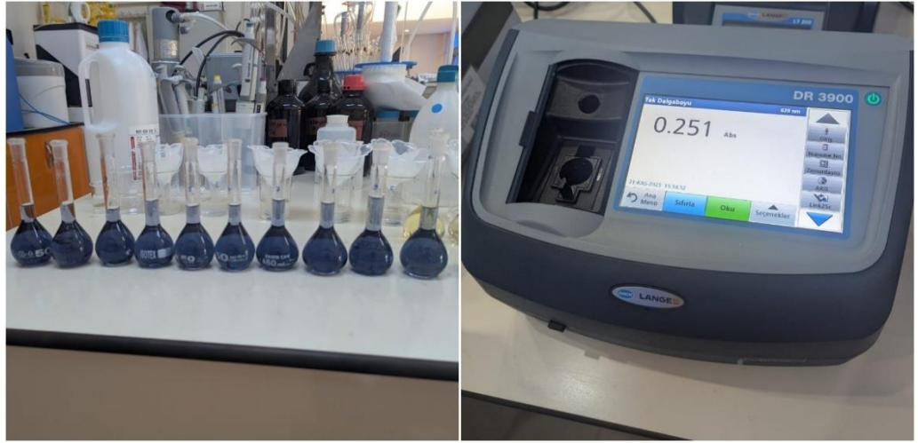
Şekil 20. Amiloz tayini: numune çözeltileri ve spektrofotometrik ölçüm aşaması
