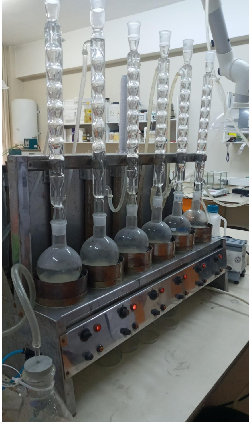
Şekil 23. Ham selüloz analizi (asit-bazla kaynatma kısmı)
