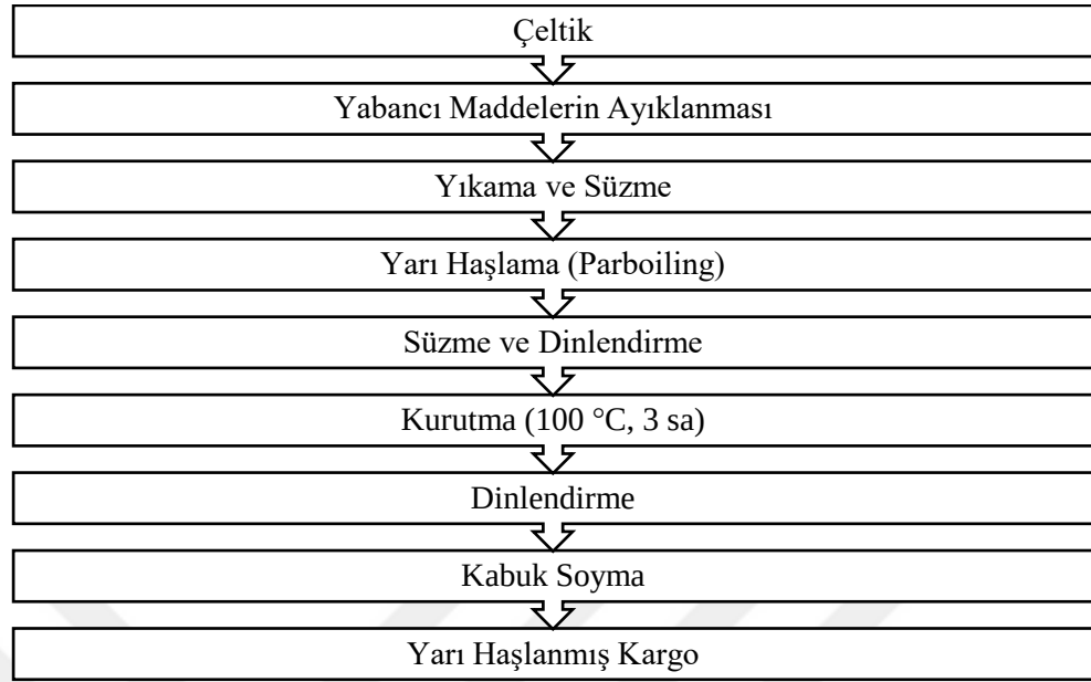
Şekil 5. Çeltikten yarı haşlanmış kargo pirinç üretim şeması
