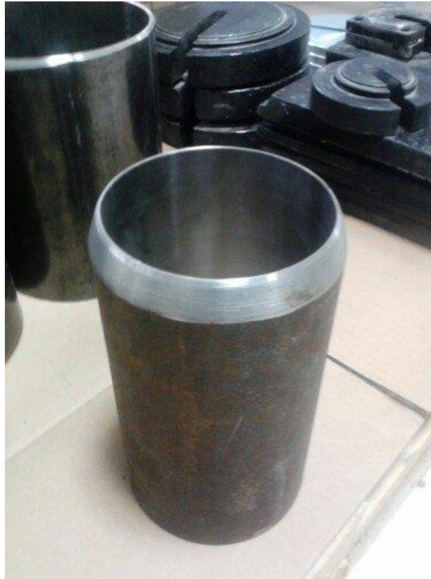
Şekil 3.14. Örselenmemiş numune almada kullanılan çelik tüp
