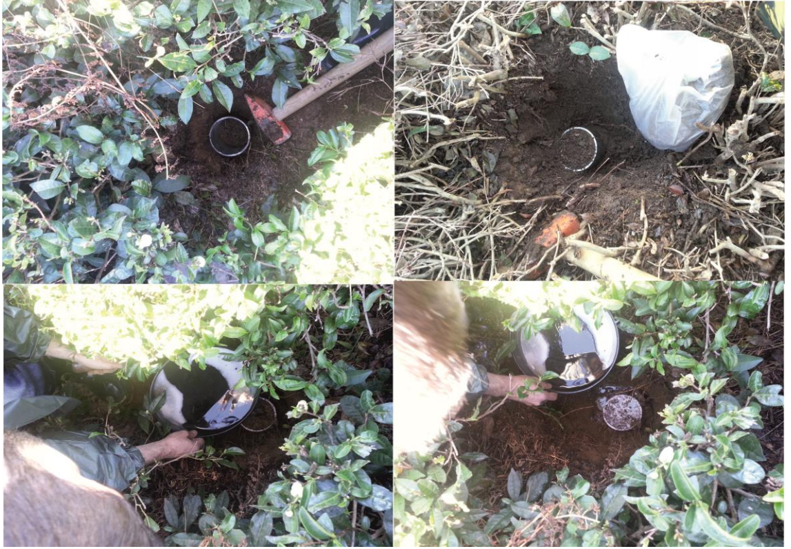
Şekil 3.23. Arazide çelik tüpler yardımıyla alınan örselenmemiş numune
