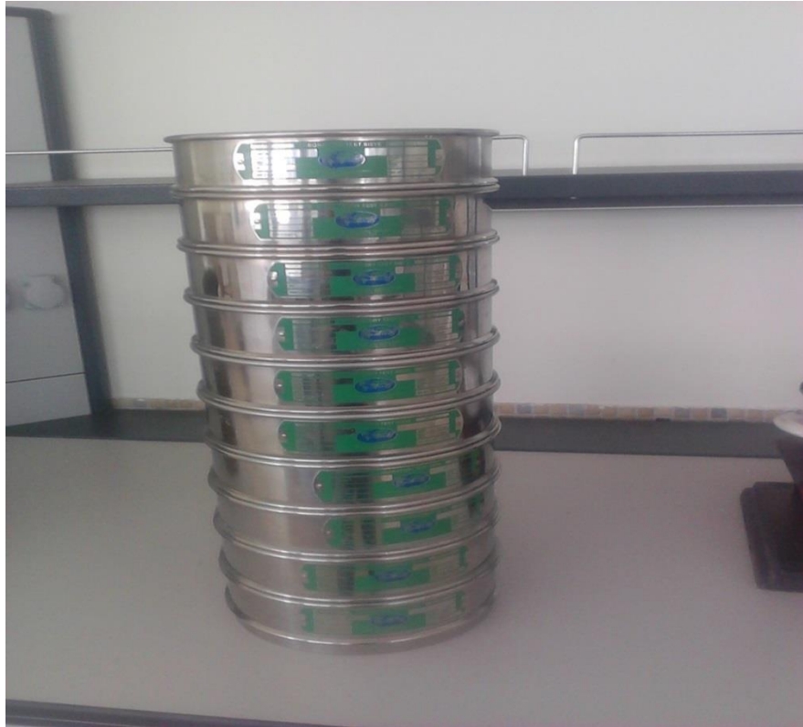
Şekil 3.15. Elek analizi için kullanılan elek takımı
