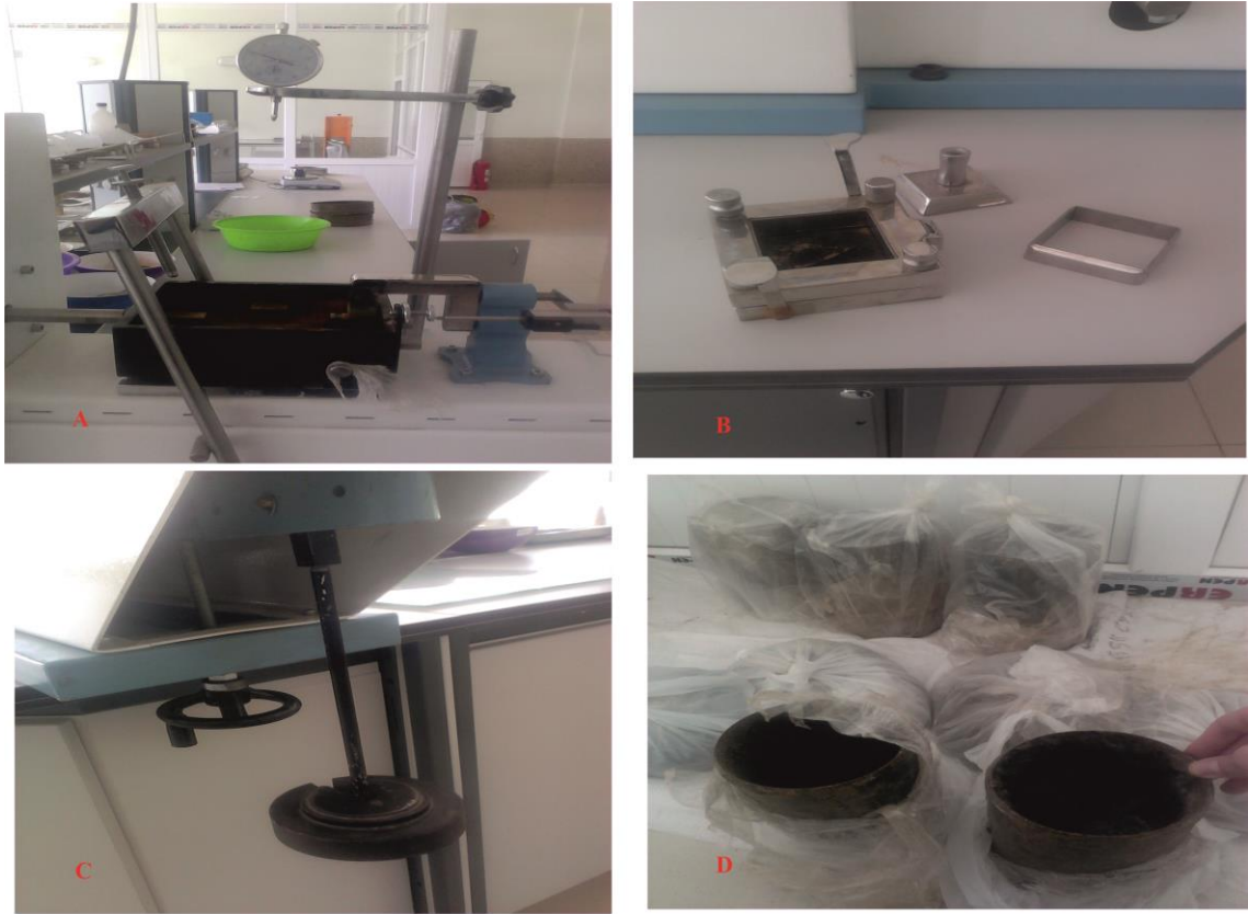
Şekil 3.25. A: Numunenin yerleştirildiği kutu, B: Numunenin koyulduğu aletler ve kare prizma, C: Ağırlık kolu, D: Çelik tüpler
