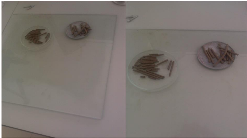
Şekil 3.22. Plastik limit deneyi için hazırlanan malzemeler
