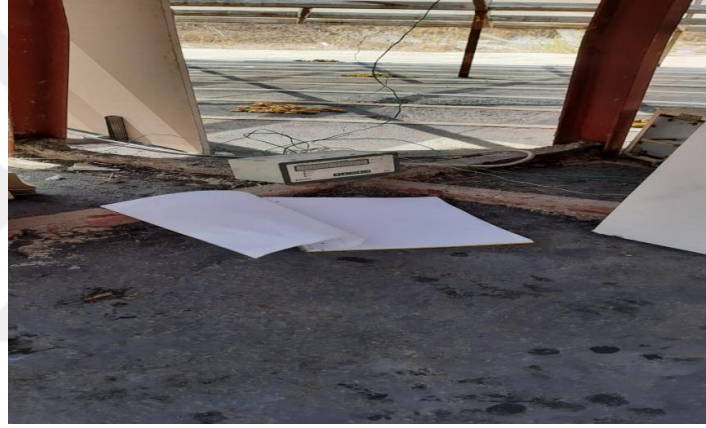
Şekil 3.23. Sıcaklık ölçümlerinin yapıldığı noktalardaki termokupllar
