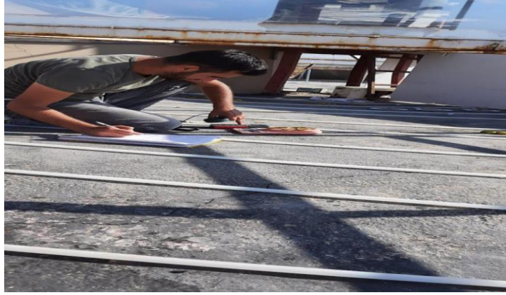
Şekil 3.24. Kurutma boyunca kütlelerin ölçülmesi
