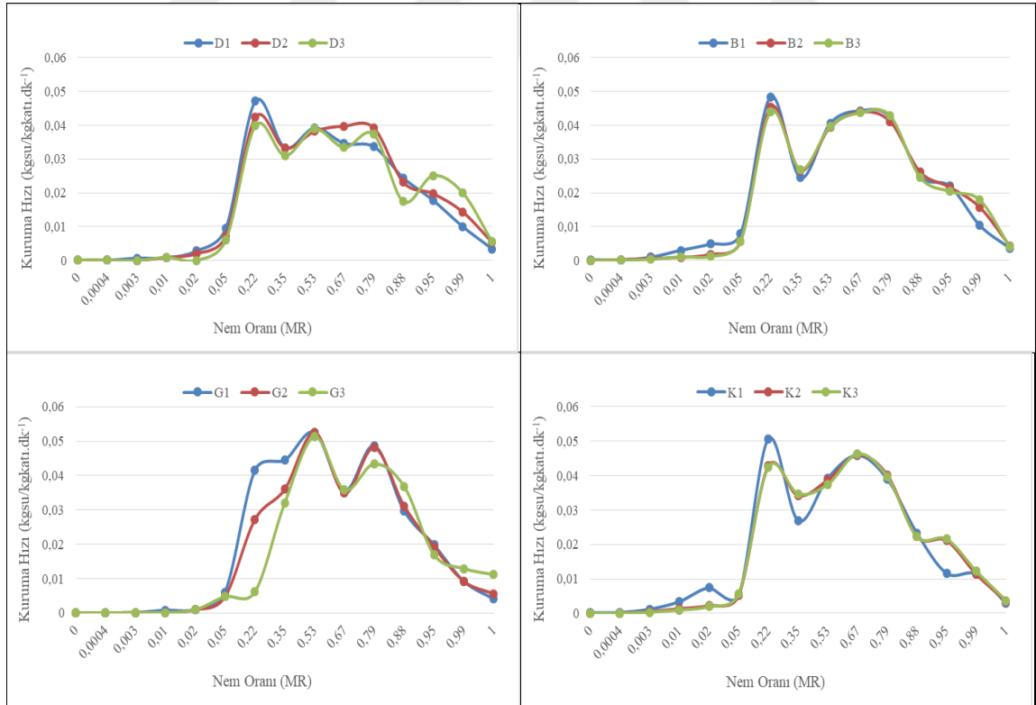
Şekil 4.32. 7 mm kalınlıktaki çileklerin kuruma hızı – nem oranı değişimi
