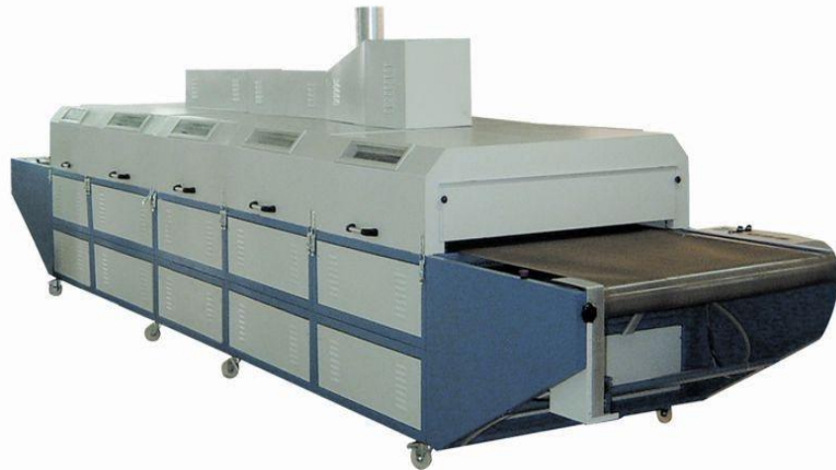
Şekil 1.11. Konveyör (Bantlı) kurutucu (Anonim, 2022i)
