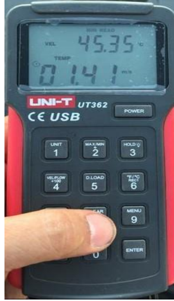
Şekil 3.32. UNIT UT362 ile sıcaklık ölçülmesi
