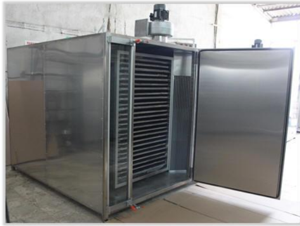
Şekil 1.9. Kabin (Tepsili) kurutucu (Anonim,2022i)
