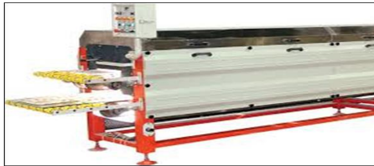
Şekil 1.10. Tünel kurutucu (Yağcıoğlu,1999)
