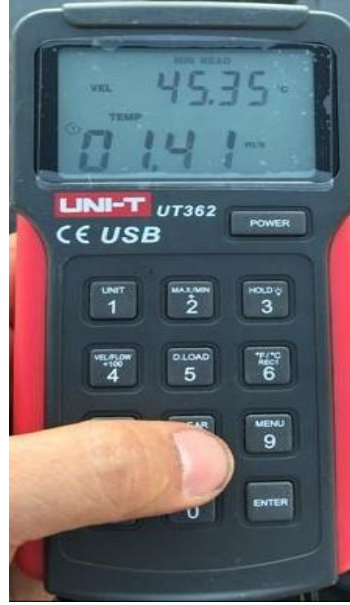
Şekil 3.32. UNIT UT362 ile sıcaklık ölçülmesi
