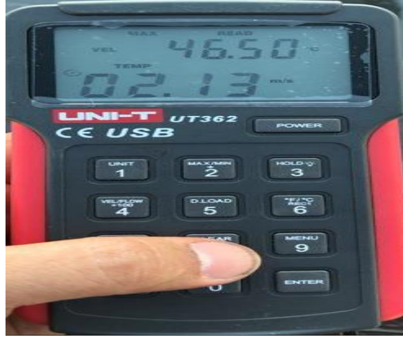
Şekil 3.34. Hava hızının ölçülmesi
