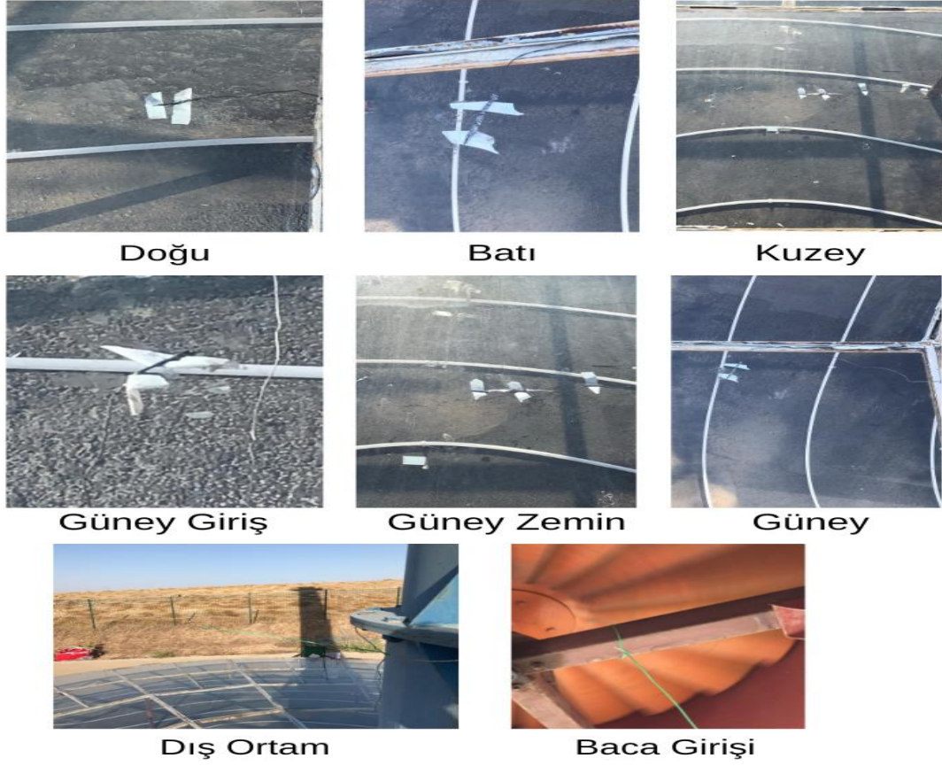
Şekil 3.30. Sıcaklık ölçümlerinin yapıldığı noktalardaki termokupllar
