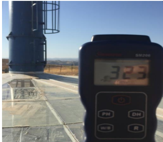
Şekil 3.35. Güneş radyasyonunun ölçülmesi
