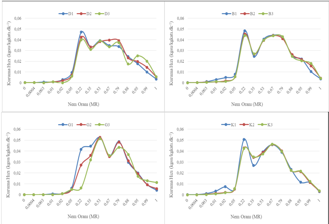
Şekil 4.32. 7 mm kalınlıktaki çilelerin kuruma hızı – nem oranı değişimi
