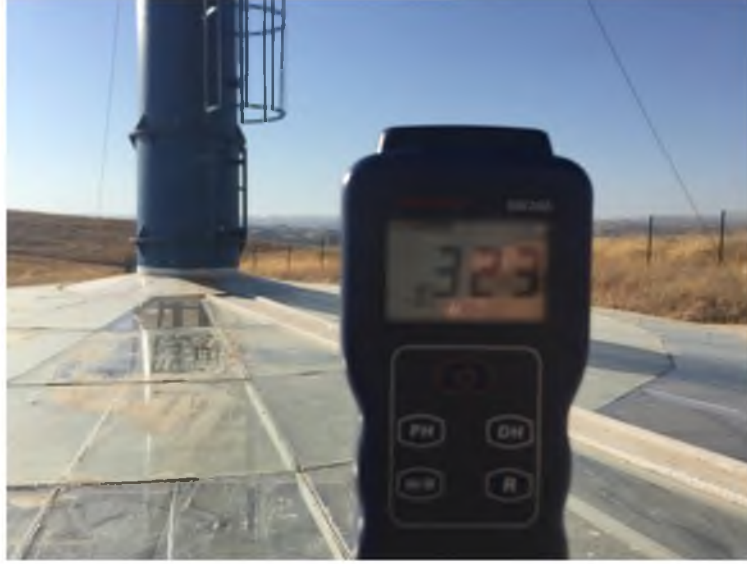
Şekil 3.23. Prototip üzerine gelen anlık ısınım miktarı ölçümü
