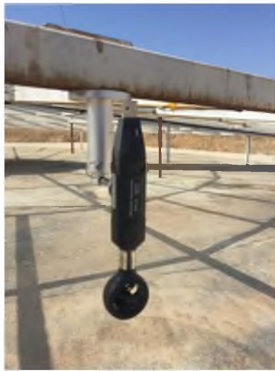
Şekil 3.22. Kolektör ağız girişindeki hava hızı ölçümü
