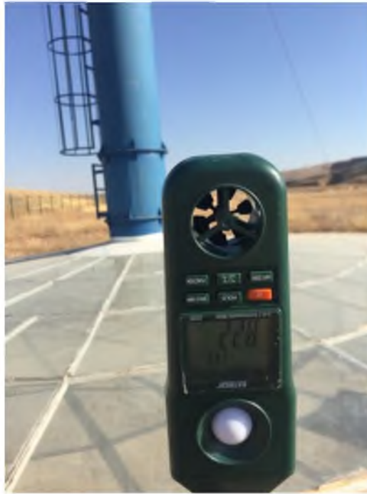
Şekil 3.24. Sistemin nem, hava hızı ve sıcaklık ölçümleri
