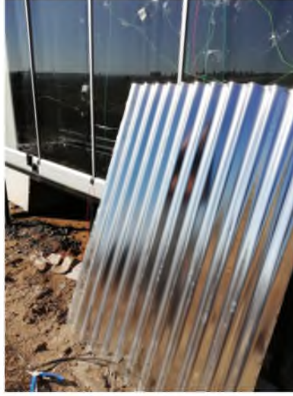
Şekil 1.3. Sinüs oluklu 76/18 trapez sac boyanmamış
