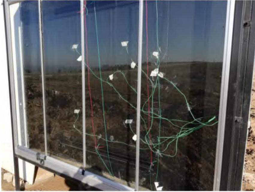
Şekil 1.6. Termal bölge ölçüm noktaları
