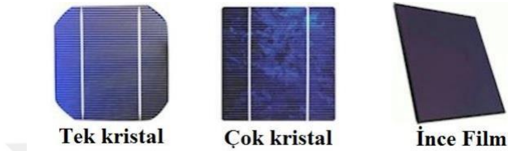
Şekil 2.6. Güneş paneli çeşitleri
