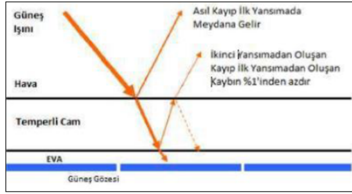
Şekil 3.19. Fotovoltaik panel yüzeyinden ışınların yansımaları (Karamanav, 2021)
