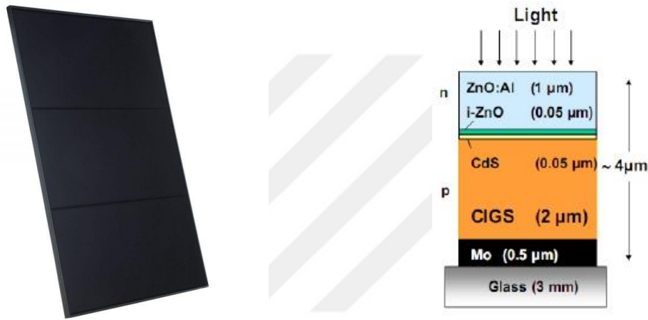
Şekil 3.17. CIGS ince film fotovoltaiik hücre yapısı (Turan, 2010; Sinetech Store,b.t).
