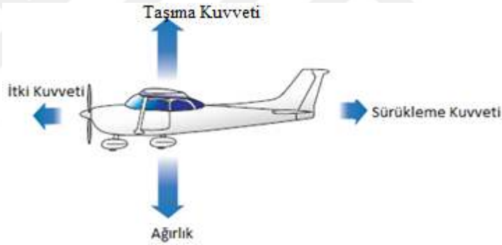
Şekil 2.1. Uçak üzerindeki temel kuvvetler (Noth, 2008)
