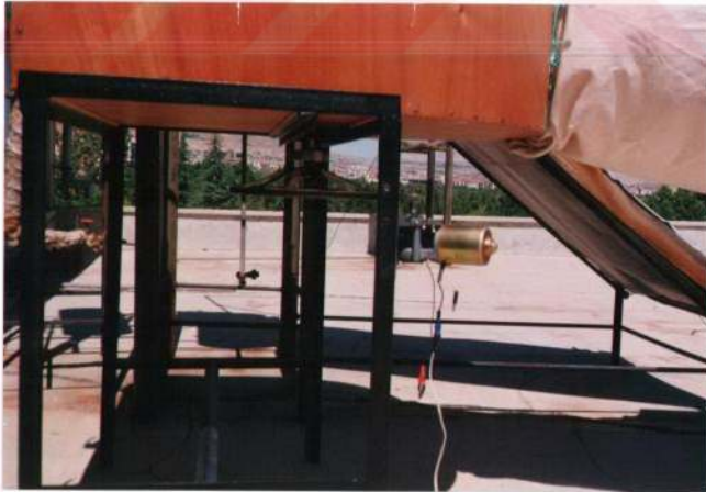
Resim 7.6 12 Voltluk Cam Silgi Motoru ile Dönme Mekanizması
