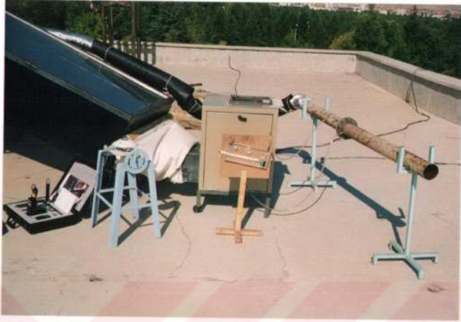
Resim 7.8 Eğik Manometreli Orifis metre İle Hava Debisinin Tespiti
