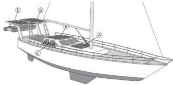
Şekil 1.13. Panel Bağlantı Gösterimi; Şekil 1.14. Panellerin Konulabileceği Alanlar (Wing, 2006)
