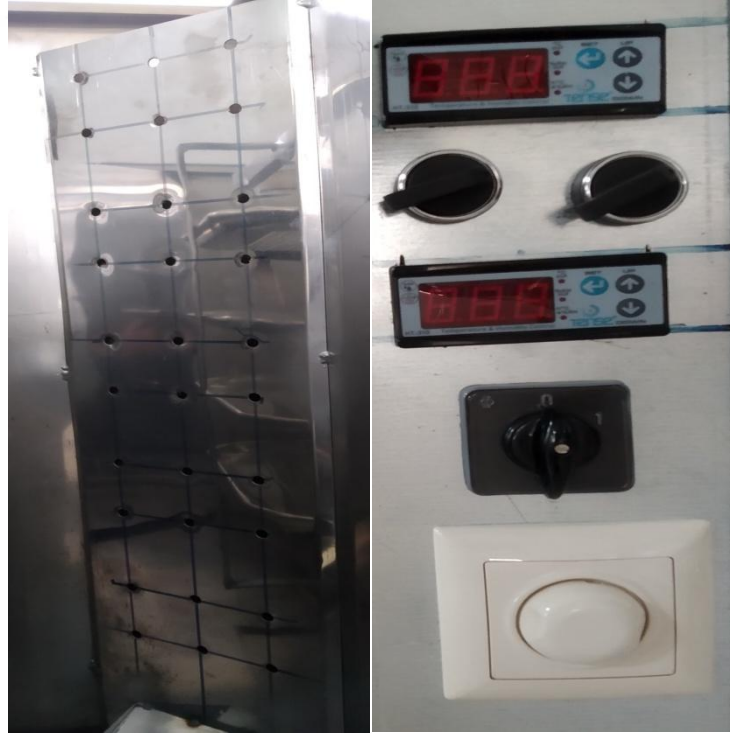
Şekil 4.13. (a-b) Fırın içerisine yerleştirilen hava yönlendirme kanalı ve kontrol ünitesi
