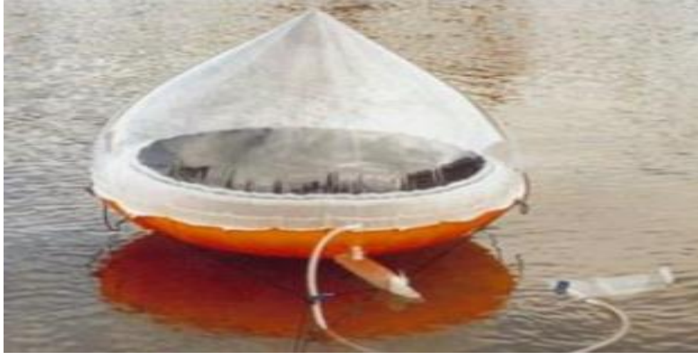
Şekil 3.5.: Güneşle su arıtma sistemi (web kaynak-7).
