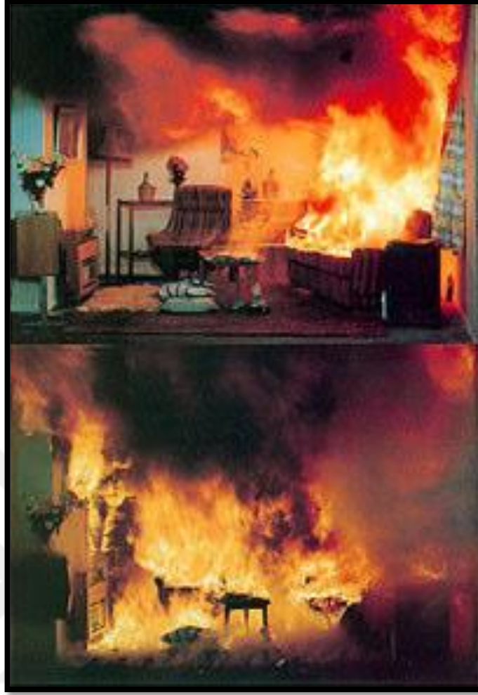
Resim 1.1. Kapalı mekandaki yangının büyüme (flashover) aşaması [24]
