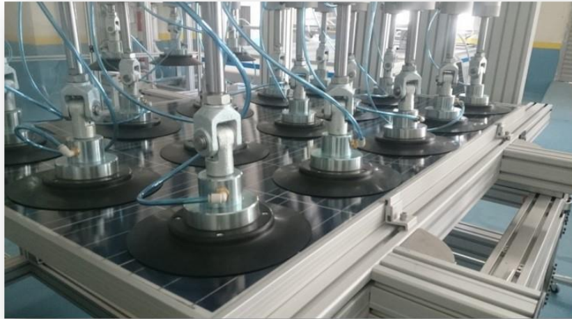
Resim 2.3. Mekanik yük deneyi.
