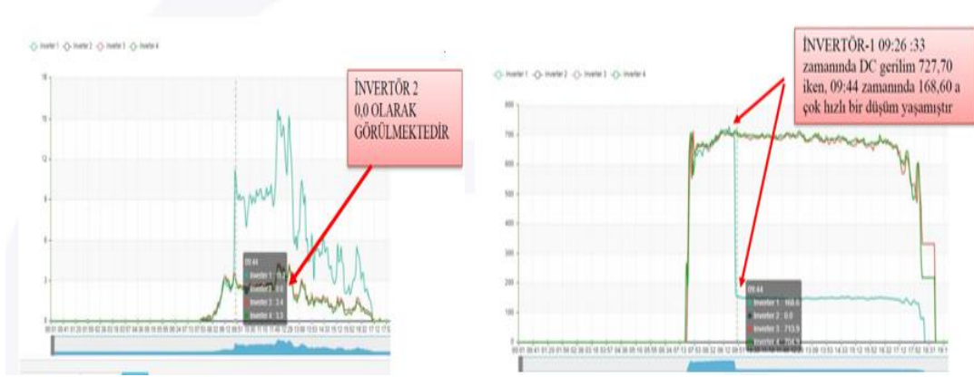
Şekil 2.6. İnvertör kayıt örneği [23].
