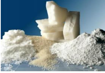
Şekil 19. RT31 FDM malzemesi (RUBITHERM)
