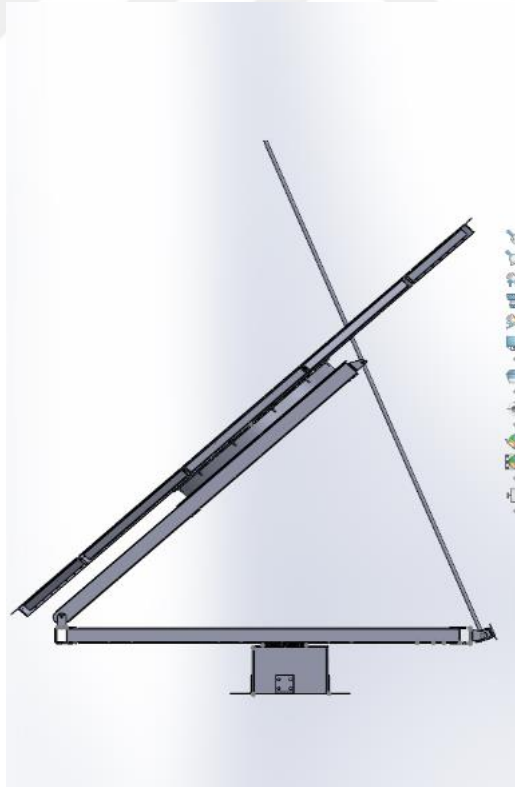
Şekil 3.28 3 metre heliostat 45 derece konumu
