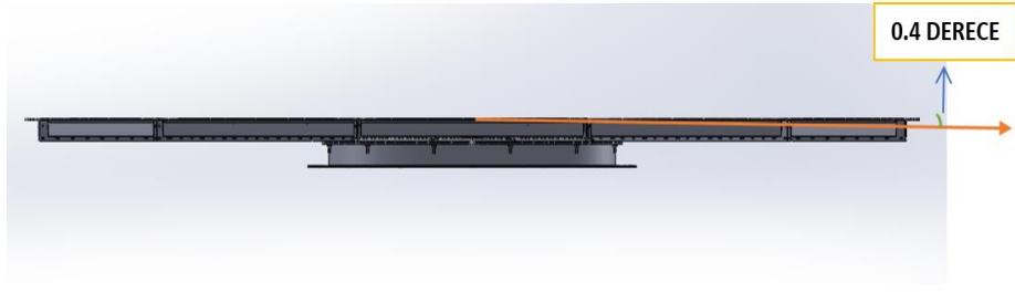
Şekil 3.31 3 metre heliostat ayna grubu montaj açısı gösterimi
