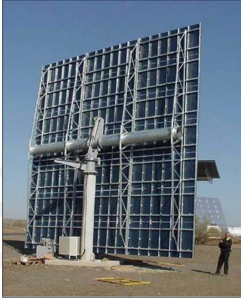
Şekil 1.9 Kaide ve çerçeve tertibatlı heliostat (Kaynak: PSA) (Bonanos vd., 2014)
