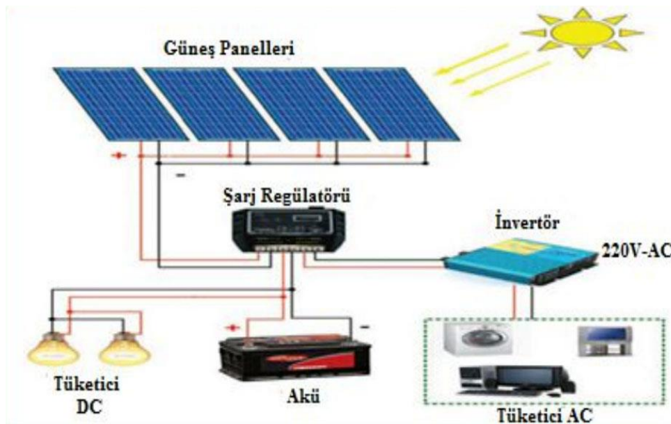
Şekil 2.22. Şebekeden bağımsız güneş enerji sistemi
