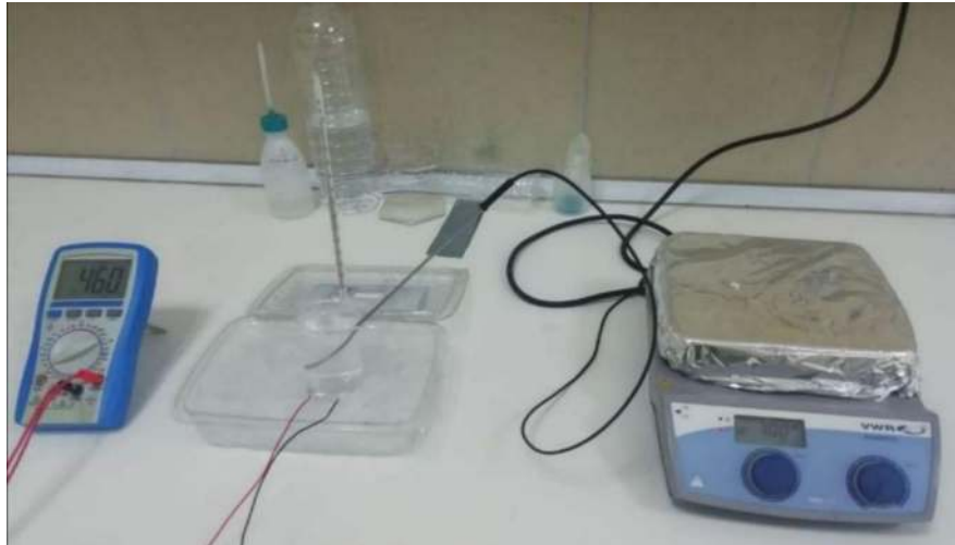
Şekil 3.4. TEC1-12706 model peltierin test edilmesinin gösterilmesi
