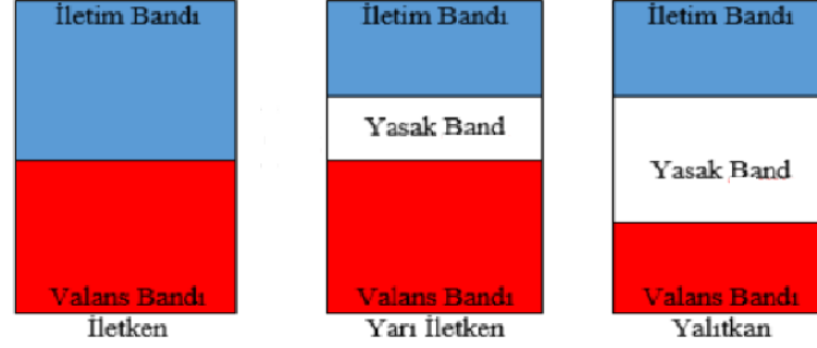
Şekil 2.1. İletken, yarıiletken ve yalıtkan malzemelerin yasak bant aralığı [20]
