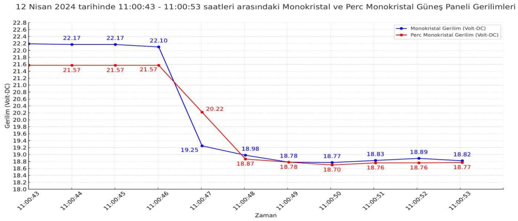
Şekil 4.21 Ani gölgelenme anında monokristal ve perc monokristal panel gerilimleri (12 Nisan).
