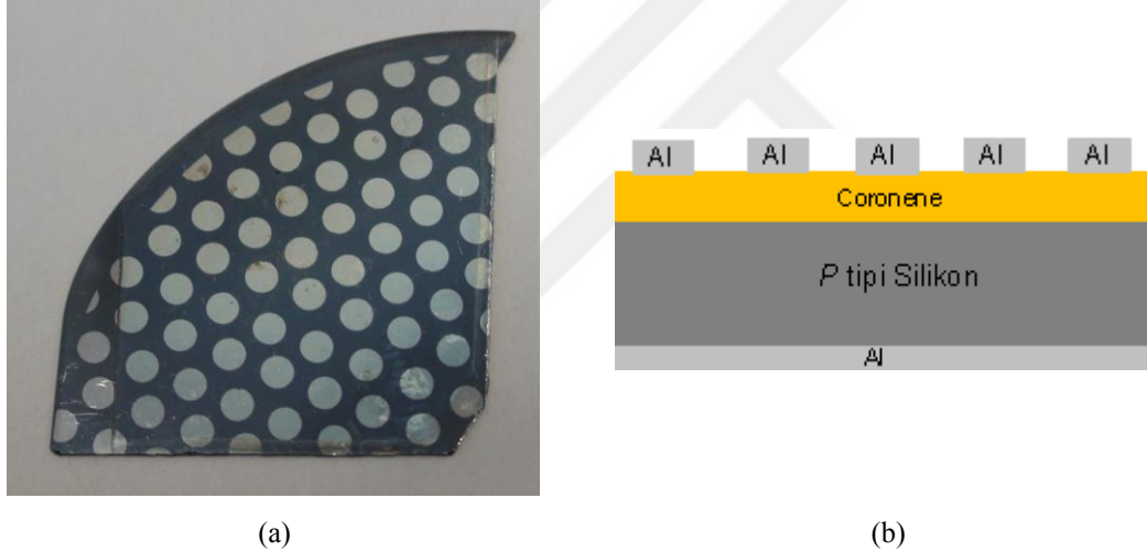
Şekil 3.9. Al/coronene/ p -Si/Al yapıları: a) Çeyrek wafer üzerinde, b) şematik diagram
