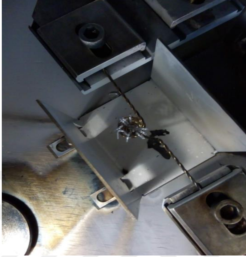
Şekil 3.7. Tungsten malzemedan yapılmış tel bir pota
