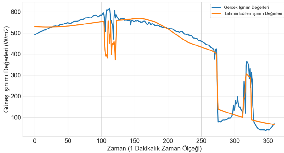
Şekil 4.26 Gerçek güneş ışınlamı değeri ile model tahminlerinin karşılaştırılması.
