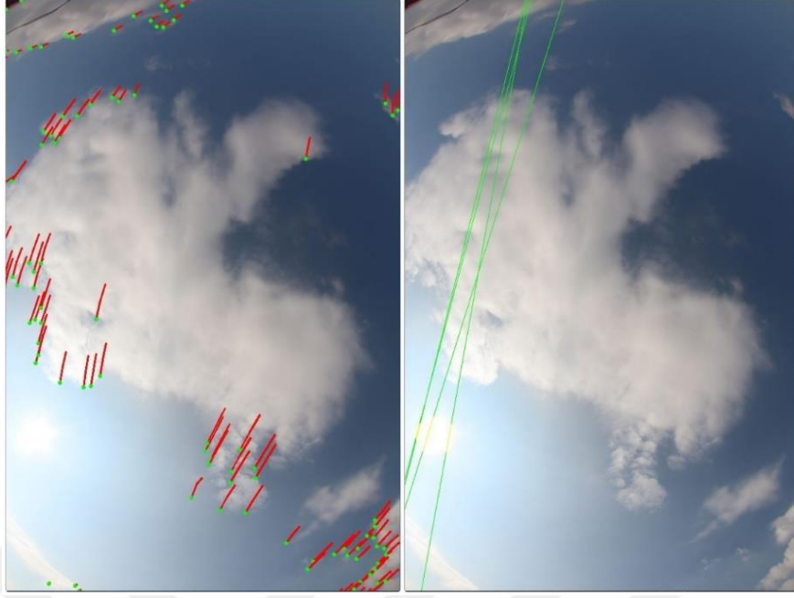
Şekil 4.5 Gerçekleştirilen bulut hareketi takibi (solda), tespit edilen tehlikeli doğrular (sağda).
