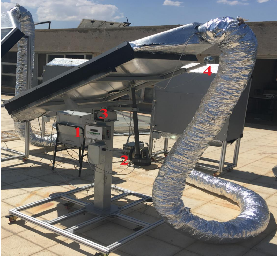
Şekil 3.4. PLC güneş takip sistemi (1-Cpu, 2-Pnomatik pistonlu Step motor, 3-Sonsuz dişli step motor, 4-Sensör)
