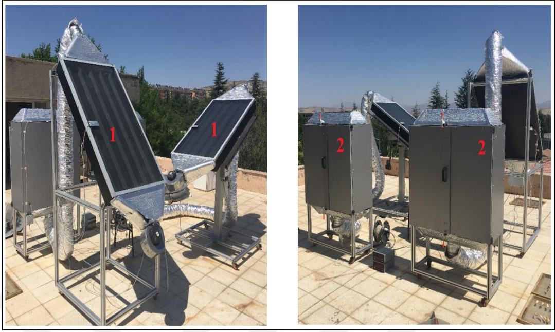
Şekil 3.2. Deney Seti (1-Hava ısıtmalı güneş kolektörü, 2-Kurutma odası)
