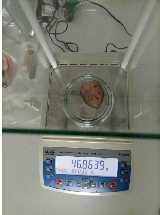
Şekil 4.4. 7 saatlik 105 derecede kurutma sonrası darası dahil son ağırlıklar
