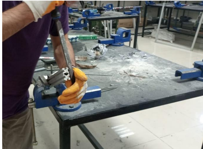
Şekil 3.22. Sigma profil tıraşlama işlemi
