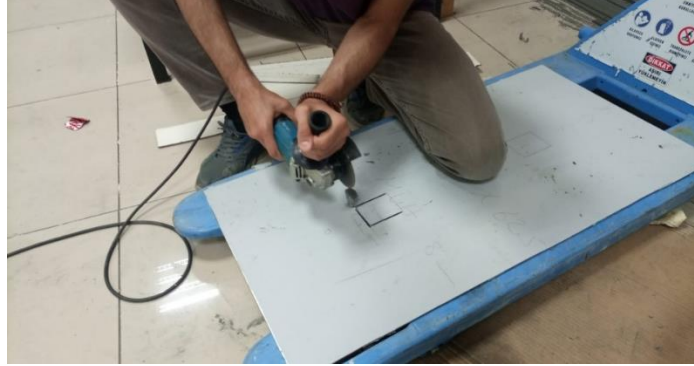
Şekil 3.23. Zemin materyalinde kurutma tepsileri için oyuk açma işlemi
