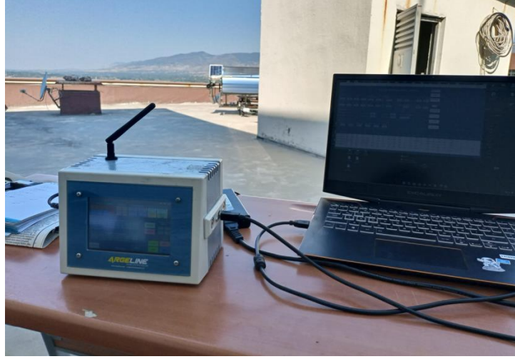
Şekil 3.3. Kurutma deneyi kontrol birimi ve takip istasyonu
