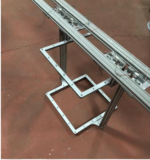
Şekil 3.9. Kurutma tepsileri ve Load cell sensörlerin yerleştirilmesi
