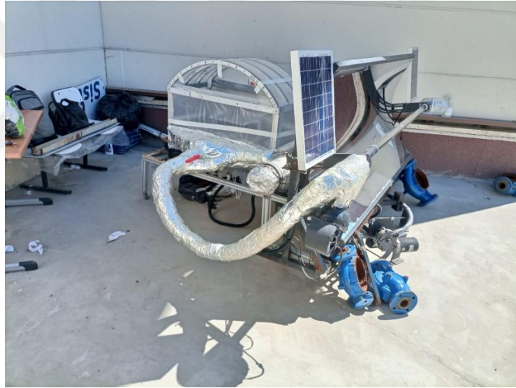
Şekil 3.32. Kurutma sisteminin vakum tüp hava iletim hattı
