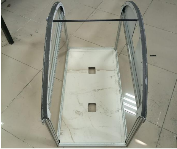
Şekil 3.26. Sera kabini çatı montajı ve havalandırma bölmesinin açılması işlemi
