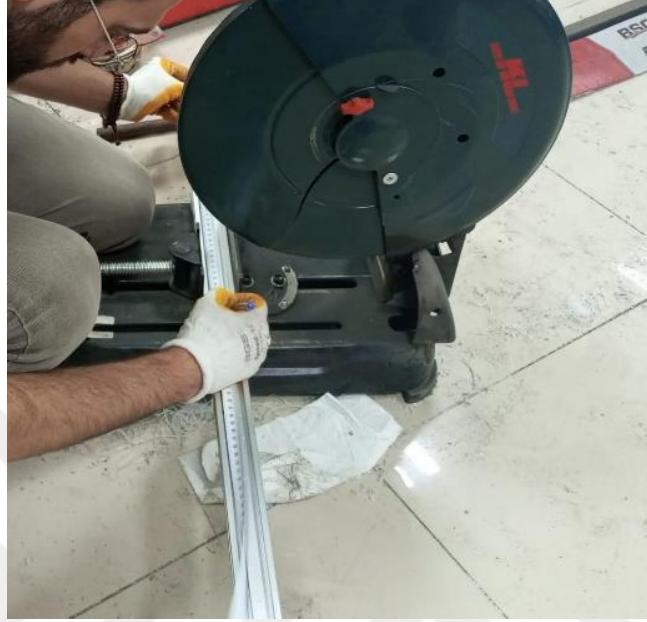
Şekil 3.21. Sera kabini dikme profil ölçeklendirme ve kesim işlemi
