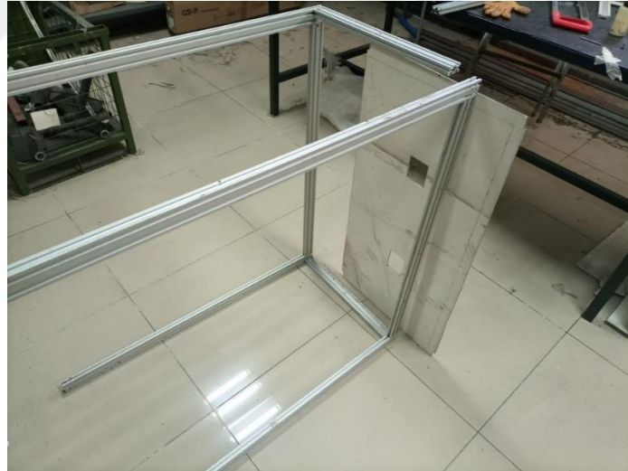
Şekil 3.24. Sera kabini dış profil montajı
