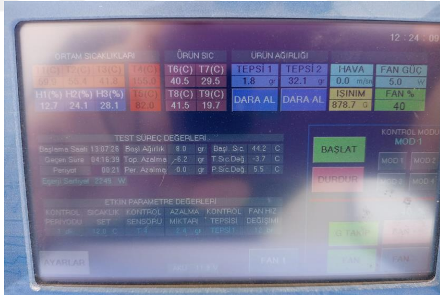
Şekil 3.4. Arduino destekli dokunmatik kontrol istasyonu ve parametreleri
