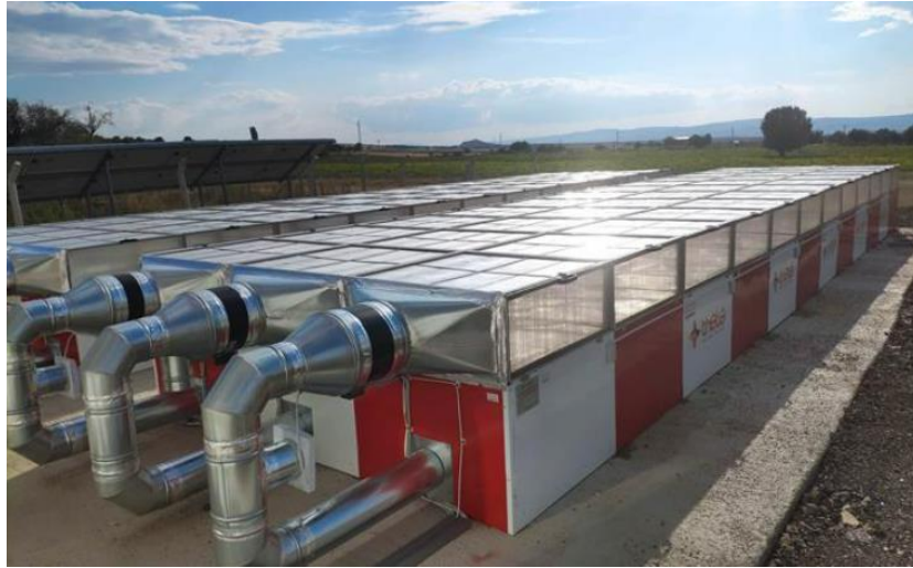
Şekil 2.6. Aktif kurutma -güneş enerjili kollektörlü sera tipli kurutma tarlası
