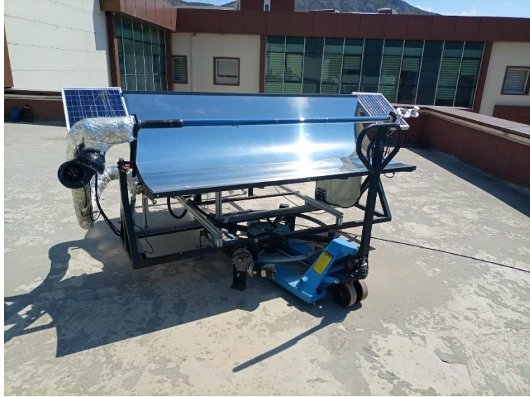
Şekil 3.17. Kurutma makinasında parabolik yüzey ve vakum tüp gösterimi
