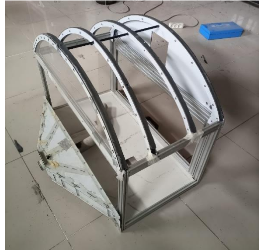
Şekil 3.26. Sera kabini çatı montajı ve havalandırma bölmesinin açılması işlemi
