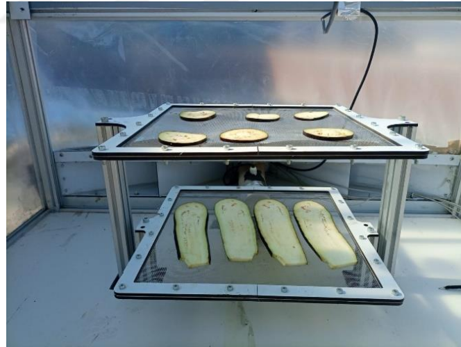
Şekil 3.10. Sera içi kurutma tepsileri ve denek patlıcan dilimleri
