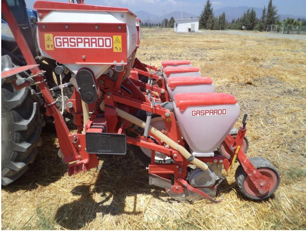
Şekil 3.3. Birinci ve İkinci Yıl mısır ekimi için kullanılan hassas ekim makinası
