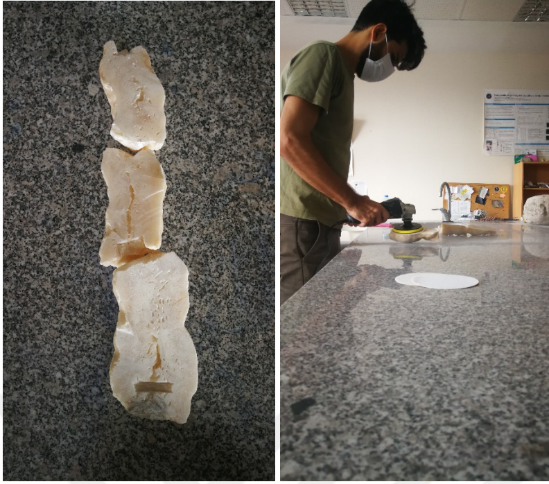
Şekil 3.3. Mol-2 örneğinin ikiye ayrılması ve parlatılması
