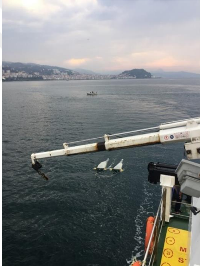
Şekil 9. Su yüzeyinden mikroplastik örneklerinin manta ağı ile toplanması
