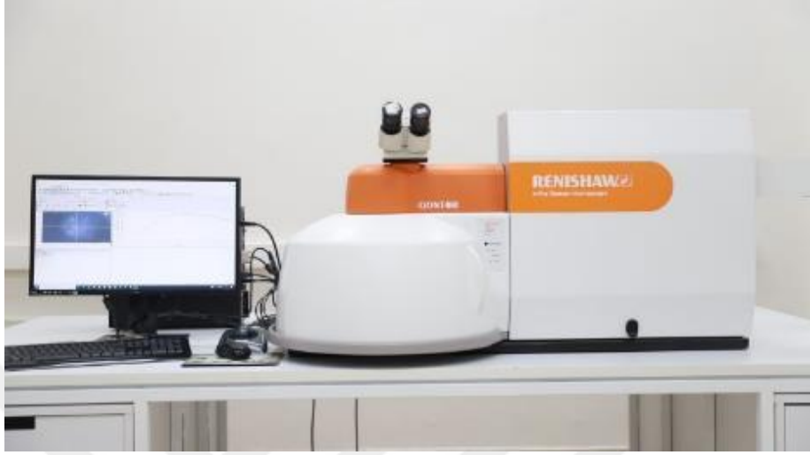
Şekil 18. Kimyasal karakterizasyonunda kullanılan Raman spektrometresi
