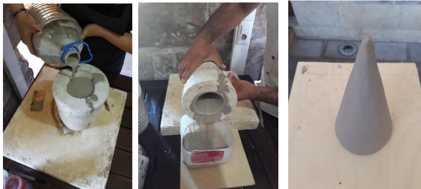
Fotoğraf 45: Alçı kalıba döküm yapılması
