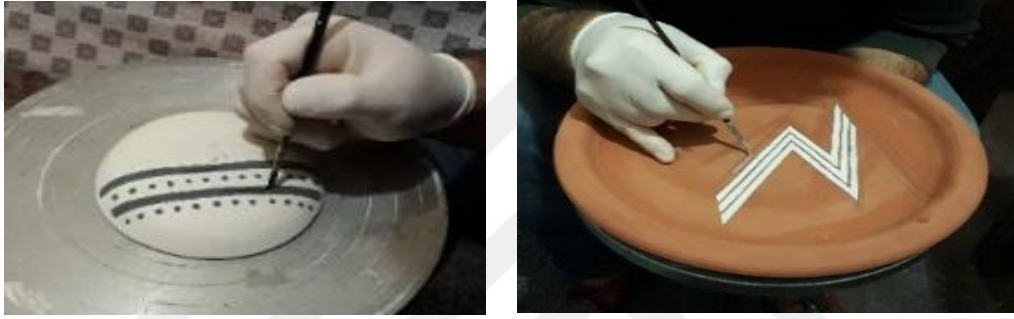
Fotoğraf 49: Astarlı ve astarsız seramik yüzeylerde dekor işlemi
