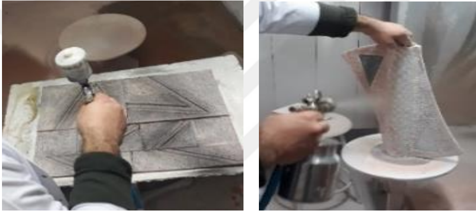
Fotoğraf 52: Püskürtme yöntemi ile sırlama
