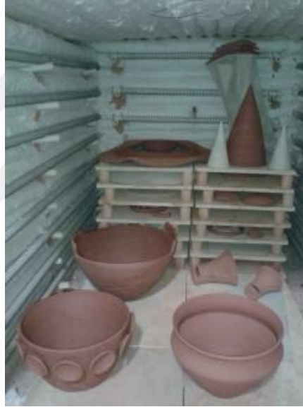
Fotoğraf 55: İlk pişirim için çalışmaların fırına yerleştirilmesi
