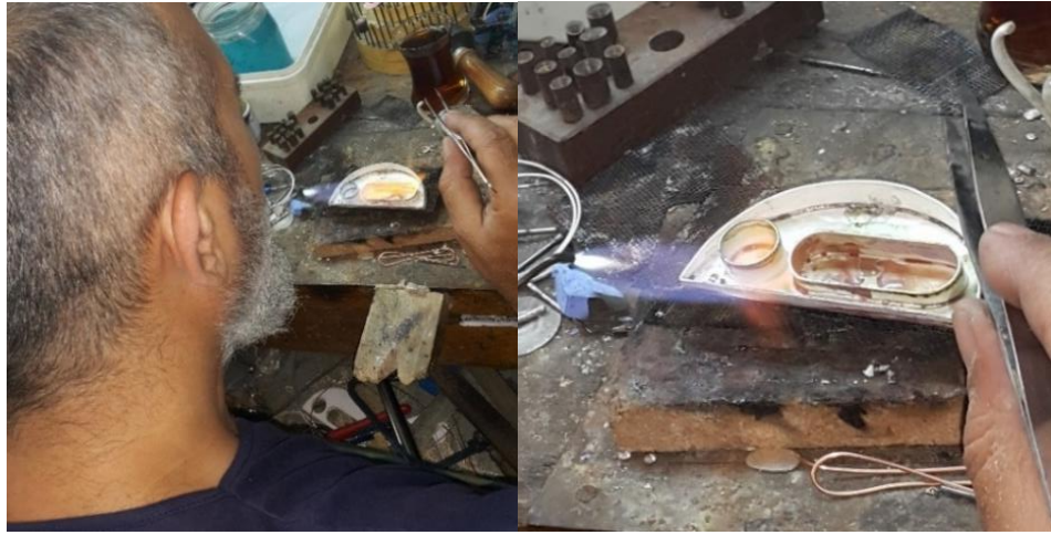
Şekil 43- Metal kısımların üretimi, kaynaklama
