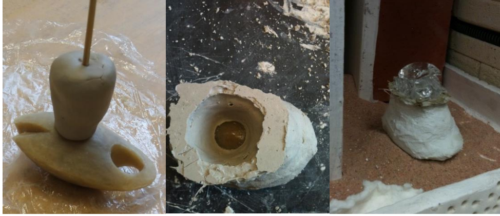
Şekil 38- Balmumu model, balmumunun uzaklaştırılması ve cam doldurma noktasının belirlenmesi, kil modeli ve pişirilmiş kalıbın cam parçalarla doldurulması
