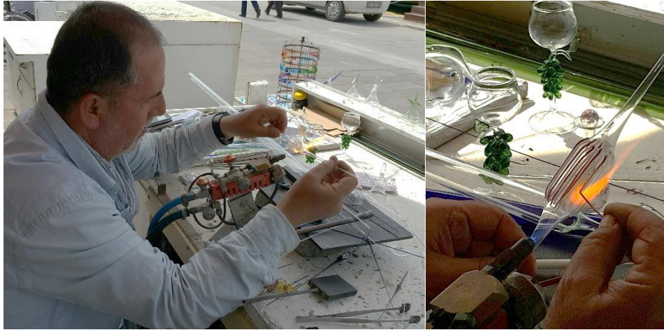
Şekil 53- Alevle Şekillendirme Tekniği ile Çeşm-i Bülbül Yapımı ve Nasuf Cömert, Bodrum, 2015
