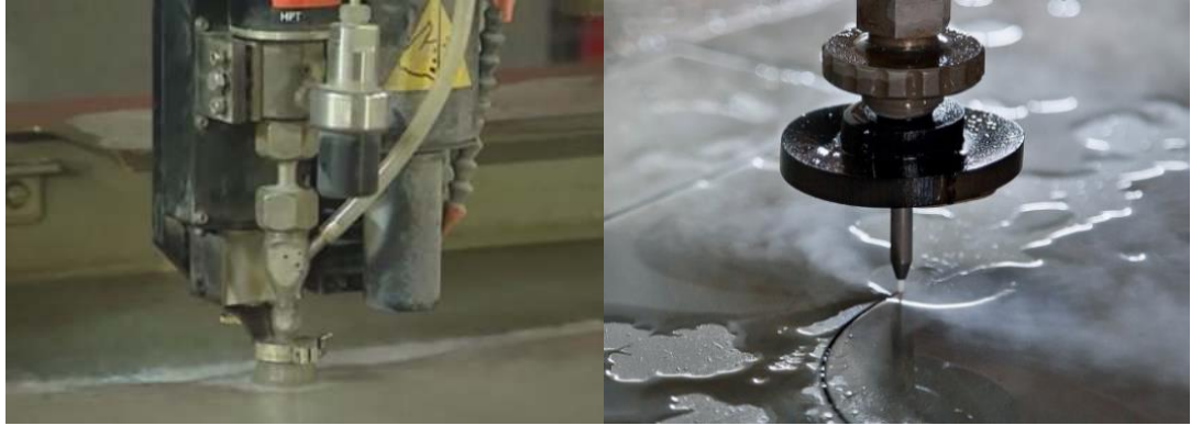
Şekil 42- Su jeti (water jet) makinesi ve kesme işlemi
