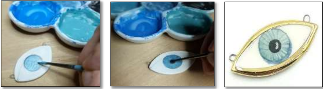
Şekil 4.19: Sıraltı Fırça Dekor Uygulama.
