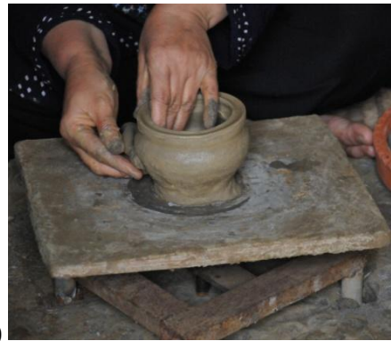
Fotoğraf 9 (a-b): Ayak ve elle çevrilen düzenek üzerinde elle bant usulü biçimlendirme, Kıbrıs ve İran a) (Vincentelli, 2003: 221) b) (Heydari, 2014: 67)
