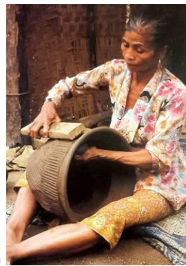
Fotoğraf 8 (a-b): Kalıba sıvama yöntemi, Banamba, Mali, Afrika ve Tokmak ile vurarak biçimlendirme, Lombok, Endonezya
