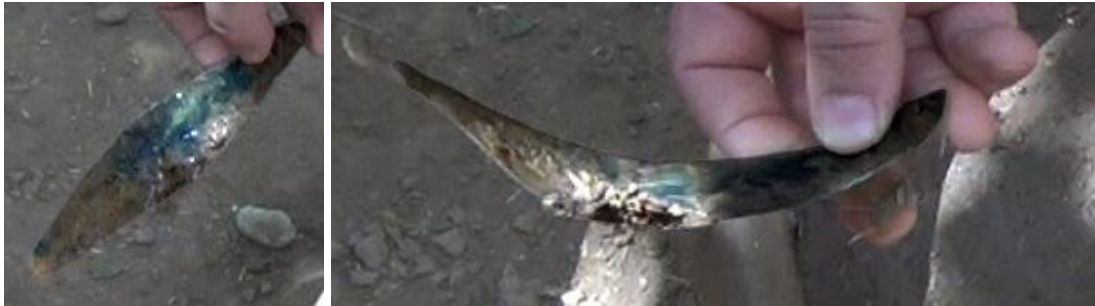
Fotoğraf 48: Ürünlerin rötuşlanmasında kullanılan tenekeden yapılmış alet
