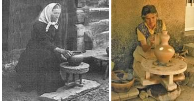
Fotoğraf 10: Turnet üzerinde elle bant usulü biçimlendirme, Slovenya ve İspanya (Carlton, Web, 2008)
