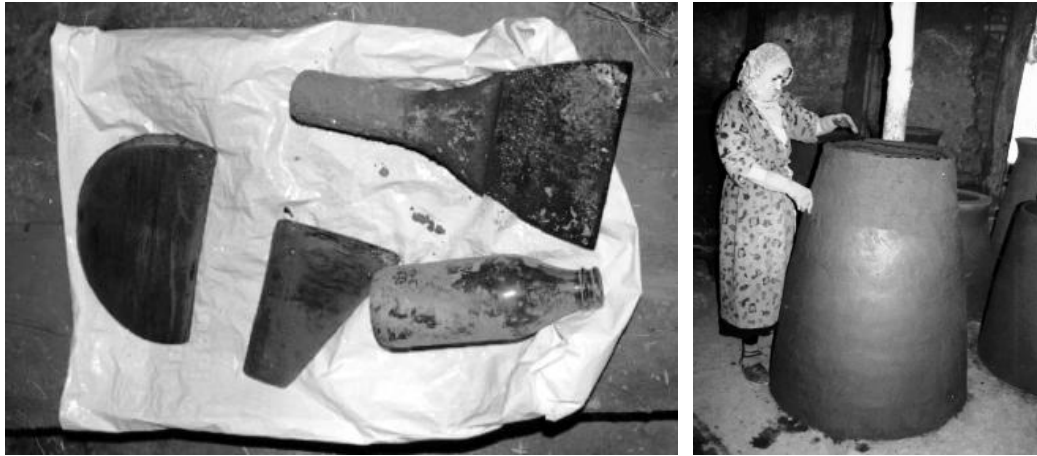
Fotoğraf 40: Biçimlendirme ve rötuş işlemlerinde kullanılan aletler ve rötuşlama işlemi
