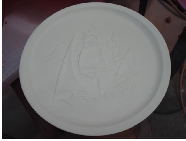
Resim No: 44 Kurutma ve rötuş işlemi sonrasında bisküvi pişirimi yapılır.
