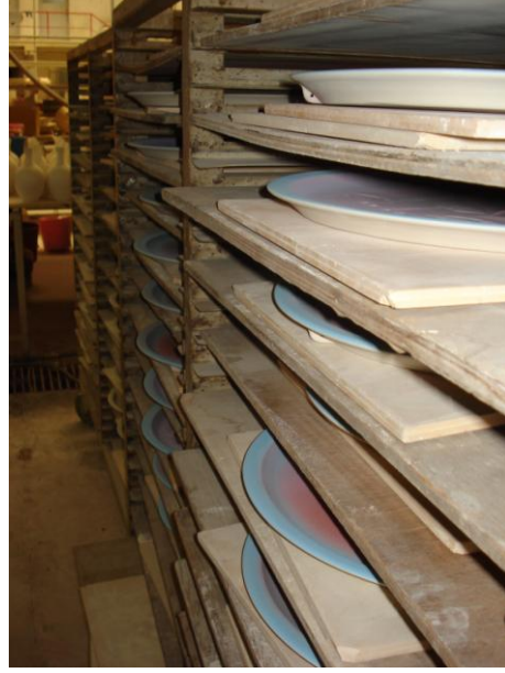
Resim No: 45 Bisküvi pişirimi olan ürün sırlanır ve sırlı pişirim için hazırdır.
