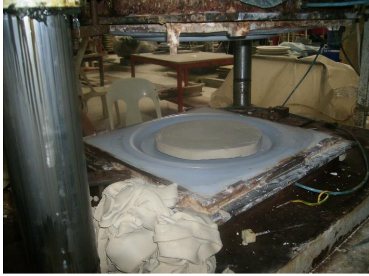
Resim No: 42 Pres arasına konan çamur presin kapanması ve uygulanan basınç ile şekillenir.
