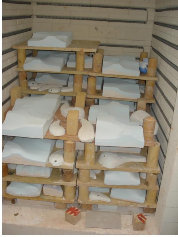
Resim No: 40 Sırlanan ürünler fırına yerleştirilir.
