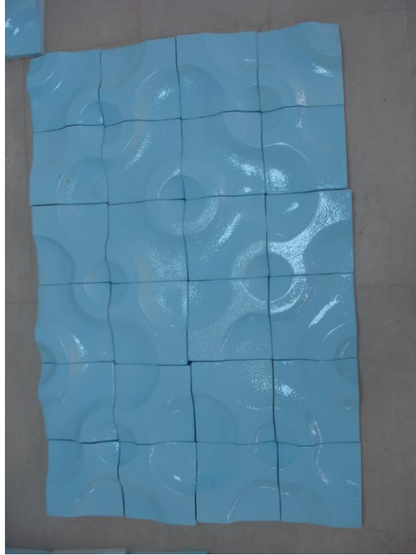
Resim No: 41 Fırınlandıktan sonra zemine yerleştirilir, montaja hazırdır.
