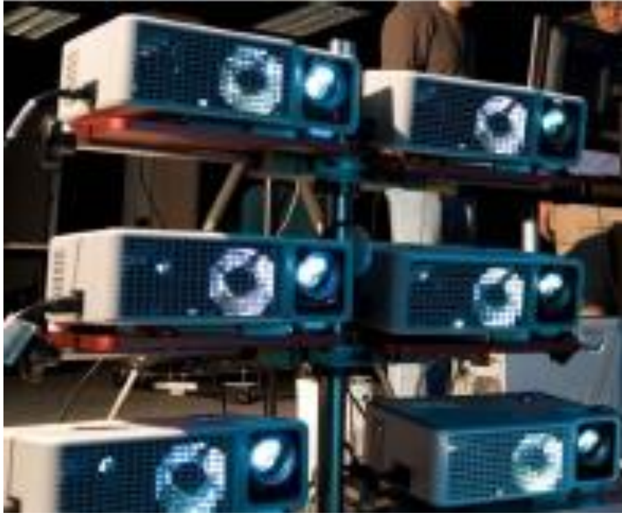
Resim 2.30: Video haritalama projeksiyonu için senkronize edilmiş çoklu projeksiyon düzeneği
