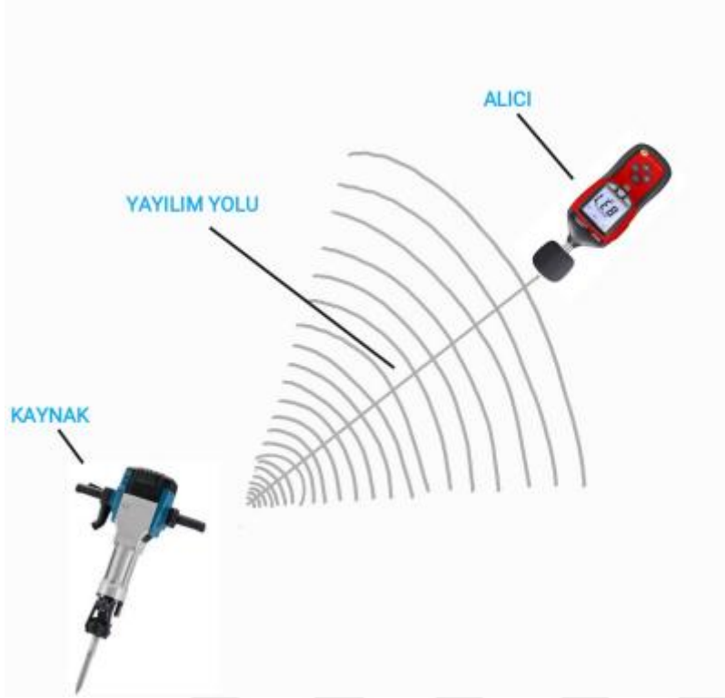
Şekil 2.9. Gürültü Kaynağının Ölçülmesi
