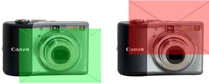
Foto 49: Kompakt Makinelerde Paralaks Hatası
