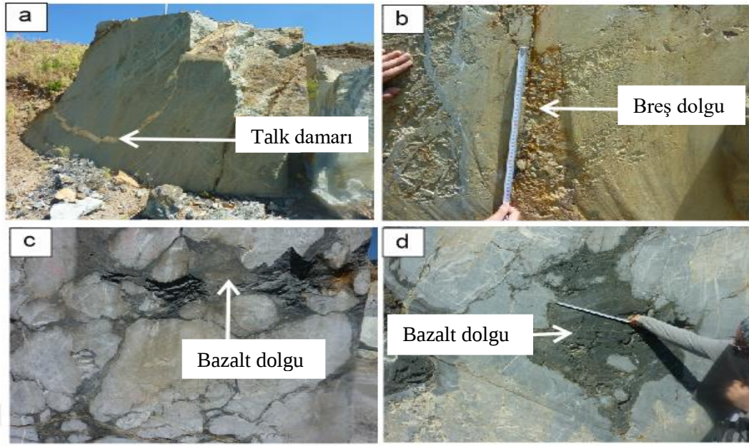
Şekil 3.14 Karabacak Serpantinitinde gözlenen dolgu malzemeleri; talk dolgu malzemesi (a) ve breş dolgu materyali içermekte (b), Karabacak Breşik Kireçtaşı bazaltik dolgu malzemeleri içermektedir (c) ve (d) (Kişisel Arşiv, 2017)
