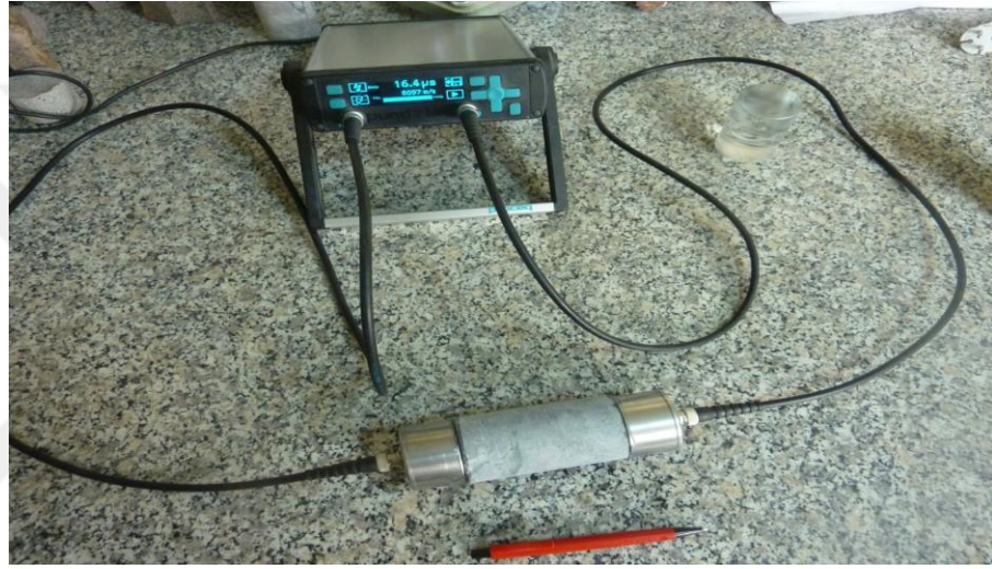
řekil 2.18 Ultrasonik hız iletkenlięi  l  m cihazı (Kiřisel arřiv, 2017)
