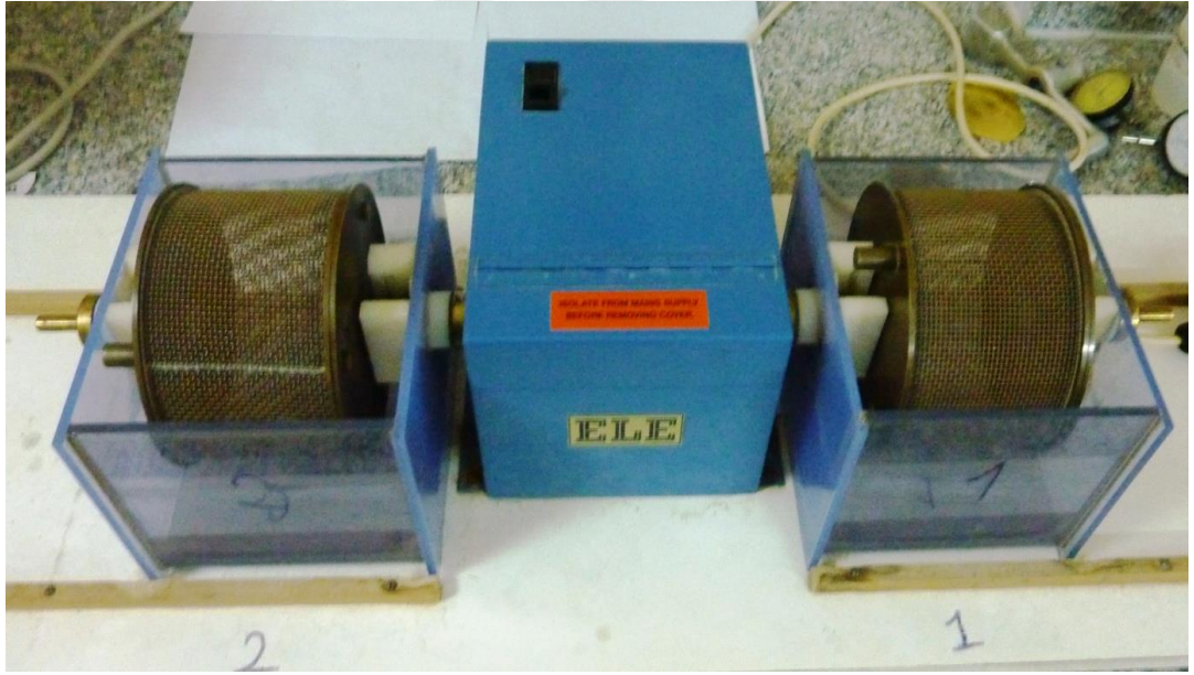
Şekil 2.58 Suda dağılmaya karşı dayanıklılık indeksi deney cihazı görünümü (Kişisel arşiv, 2017)
