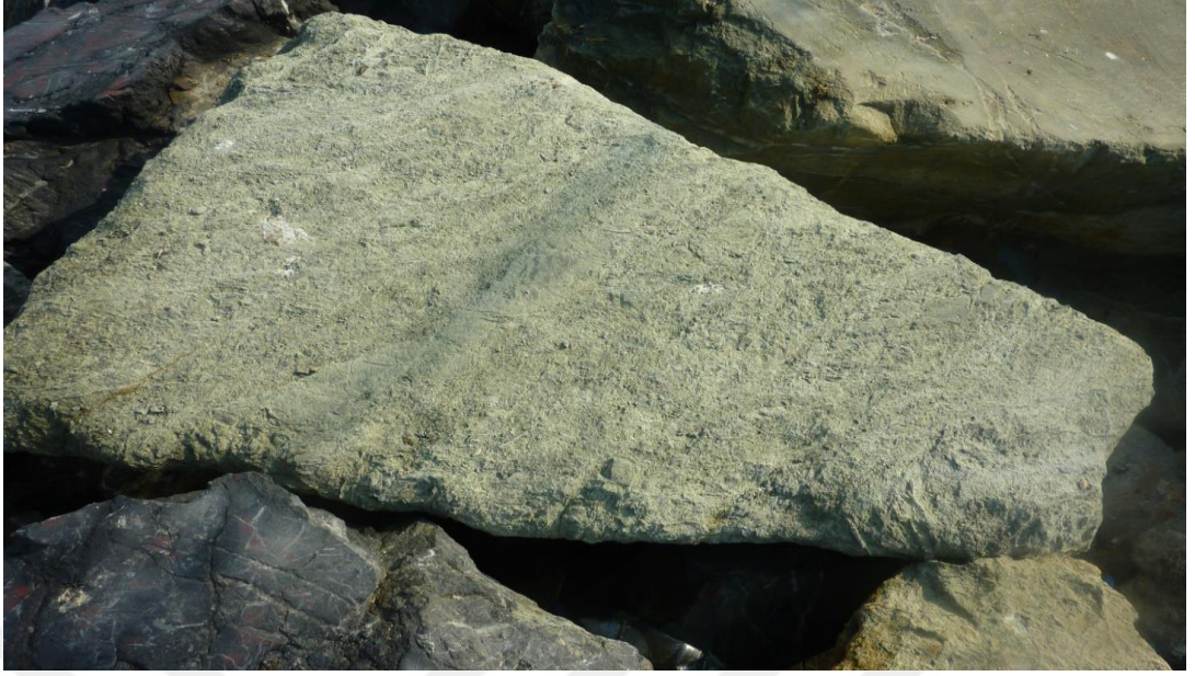
Şekil 7 Ayrıışmış Karabacak Serpantinitde gözlenen bozunmalar (Kişisel arşiv, 2016)
