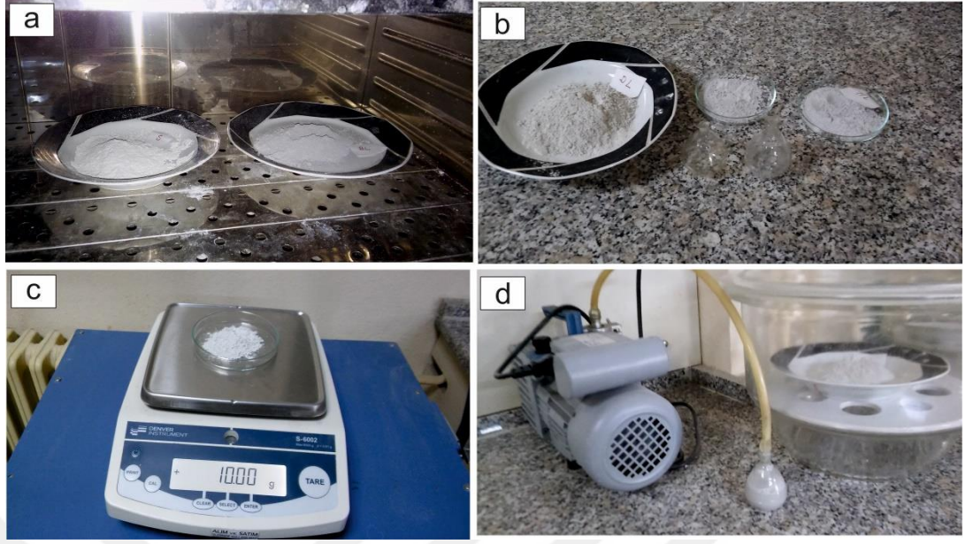
Şekil 2.17 Özgül ağırlık deney süreci: örneklerin kurutulması (a), örnekler ve piknometreler (b), hassas terazi ile ölçüm (c), ve hava boşaltma işlemi (d) (Kişisel arşiv, 2017)
