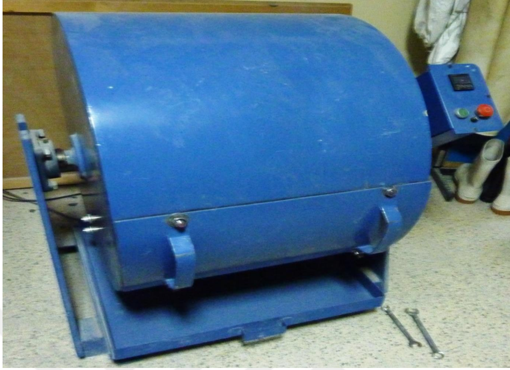
Şekil 2.28 Los Angeles darbeli aşınma kaybı deney makinesinin genel görünümü (Kişisel arşiv, 2017)
