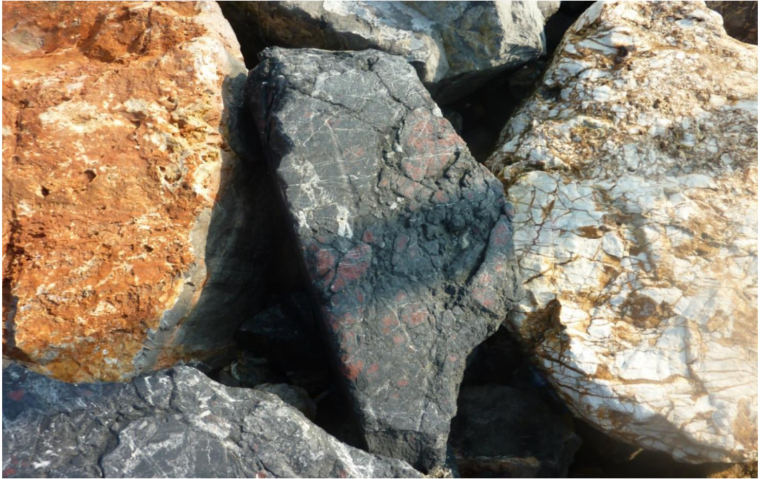
Şekil 8 Karabacak Breşik Kireçtaşı blok zırh taşında görülen bozunmalar (Kişisel arşiv, 2016)
