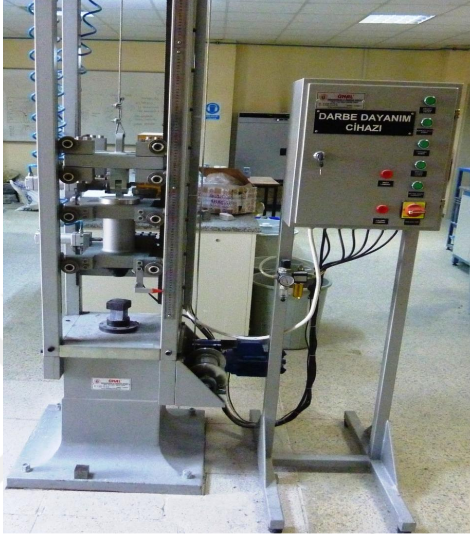
Şekil 2.26 Darbe direnci deney cihazının görünümü (Kişisel arşiv, 2017)
