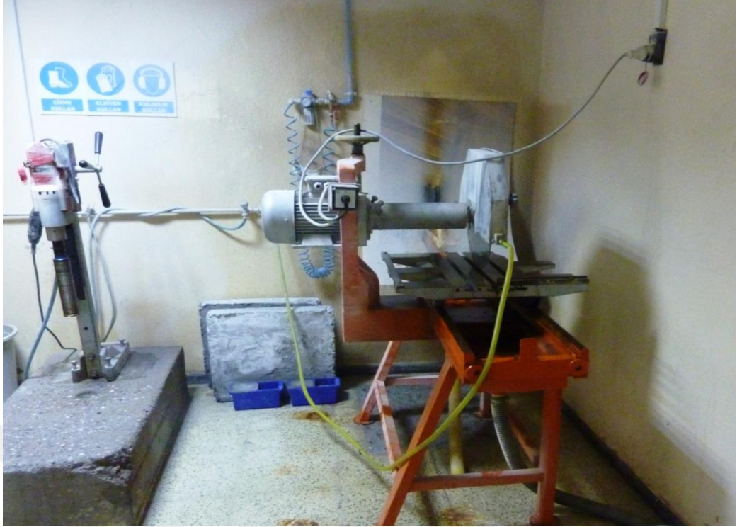
Şekil 2.20 Karot alma ve taş kesme makineleri (Kişisel arşiv, 2017)
