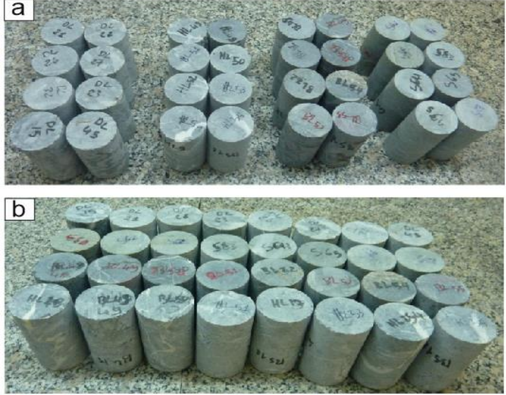
řekil 2.46 Donma-çözünme deneyi uygulanan kaya numunelerinin görünümü; deney öncesi (a) ve deney sonrası (b)
