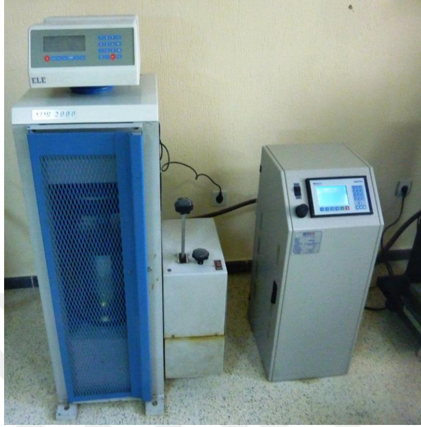
Şekil 2.21 Tek eksenli basınç direnci deney makinesi (Kişisel arşiv, 2017)
