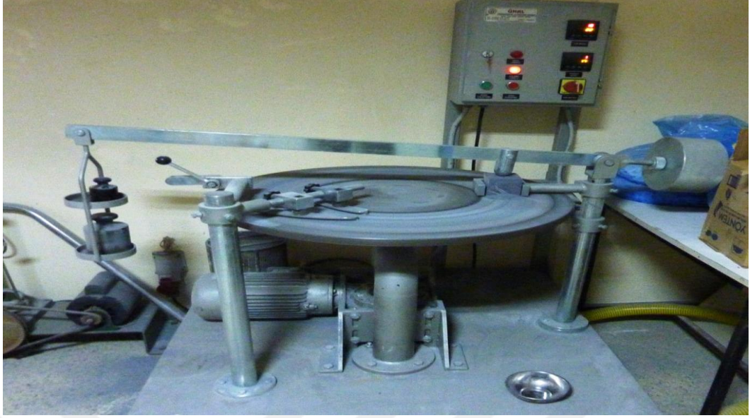
Şekil 2.34 Böhme yüzeyel aşınma kaybı deney makinesi görünümü (Kişisel arşiv, 2017)
