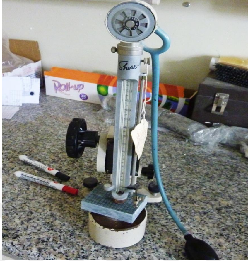
Şekil 2.38 Shore sertlik indeks deney cihazı görünümü (Kişisel arşiv, 2017)
