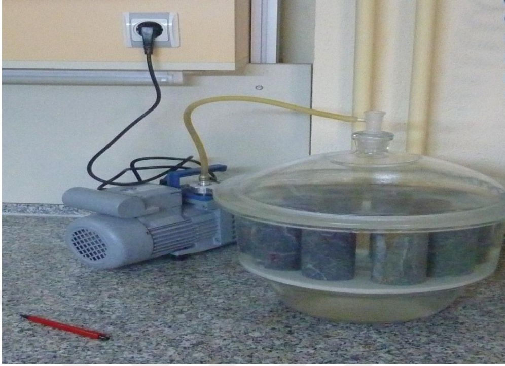
Şekil 2.61 Doygunluk katsayısı deney cihazı görünümü (Kişisel arşiv, 2017)
