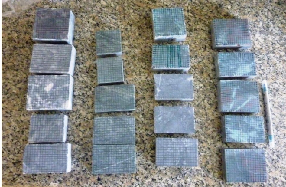
Şekil 2.39 Shore sertlik indeks deneyi için hazırlanan numunelerin genel görünümü (Kişisel arşiv, 2017)
