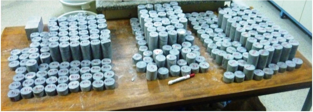
Şekil 2.19 Tek eksenli basınç direnci, nokta yükleme dayanım indeksi ve Brazilian (in-direkt) çekme direnci deneyleri için hazırlanan karot numuneleri (Kişisel arşiv, 2017)
