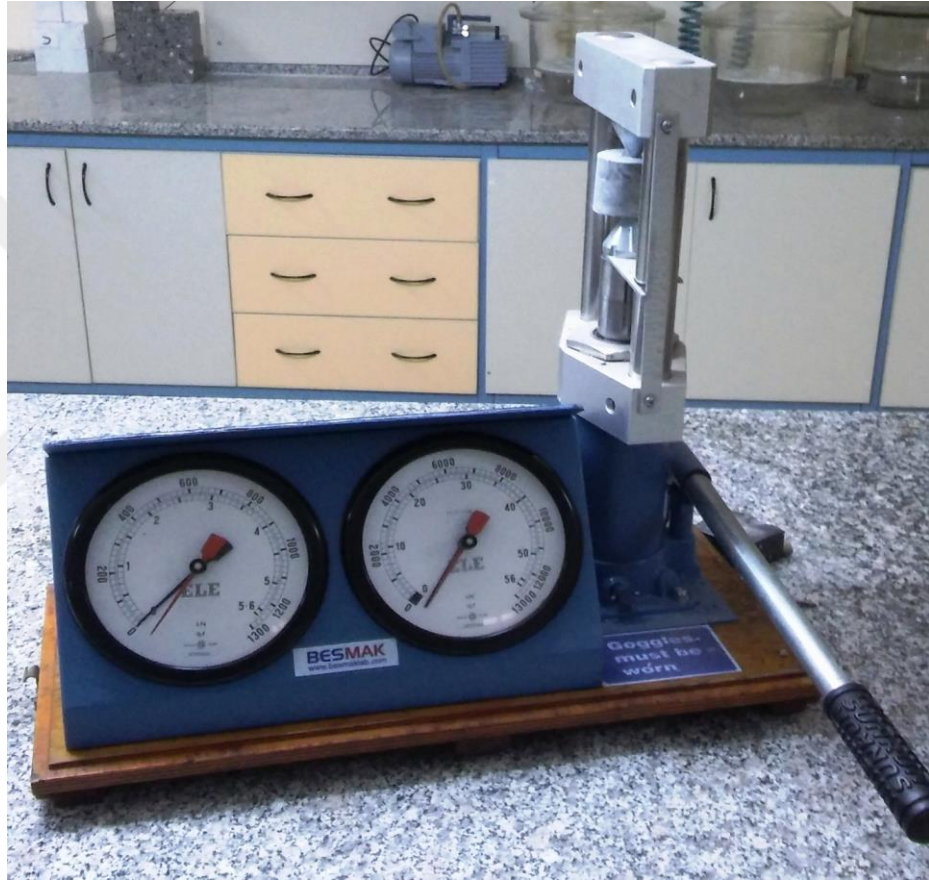
Şekil 2.23 Nokta yükü dayanım indeksi deney makinesi (Kişisel arşiv, 2017)
