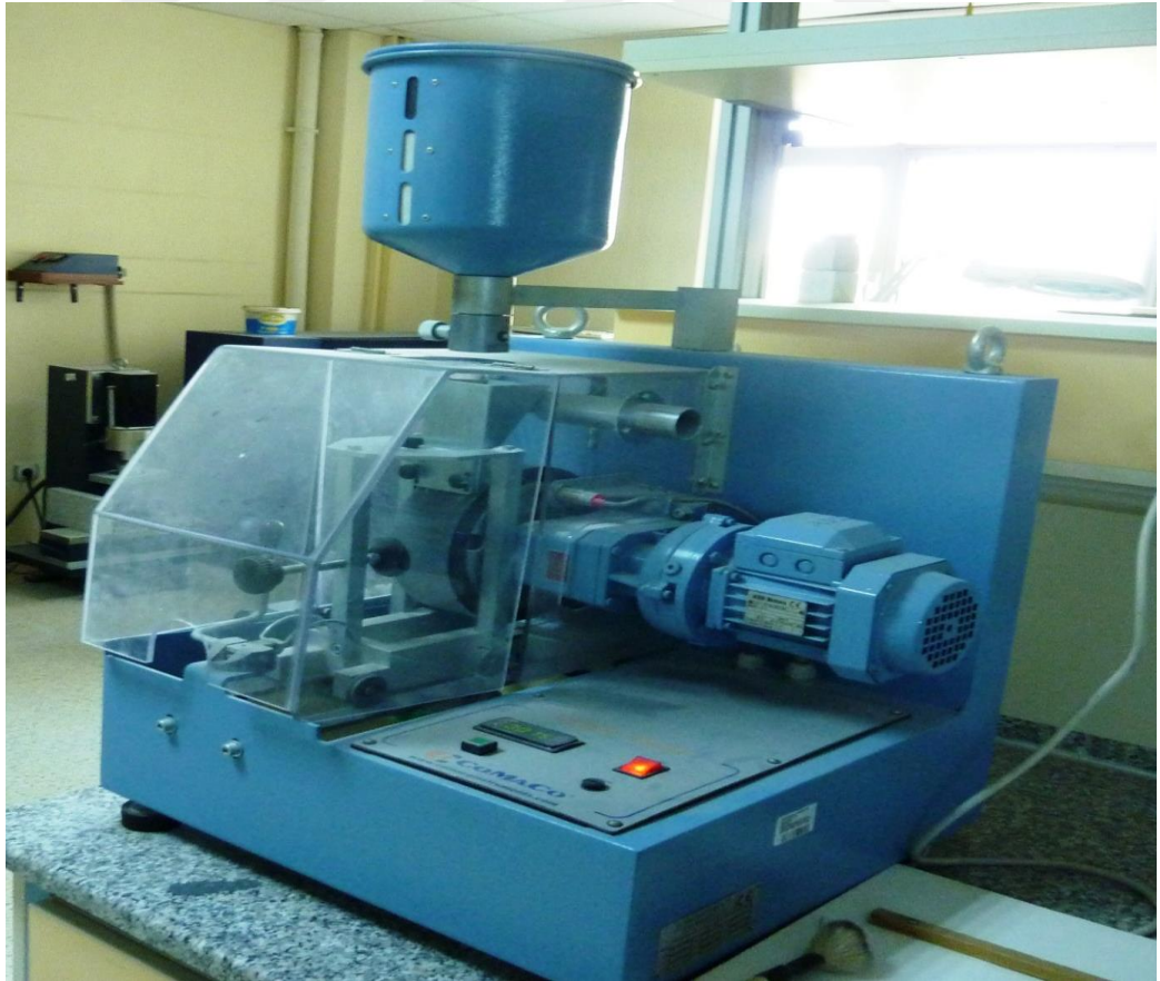
Şekil 2.36 Disk aşınma kaybı deney makinesi görünümü (Kişisel arşiv, 2017)
