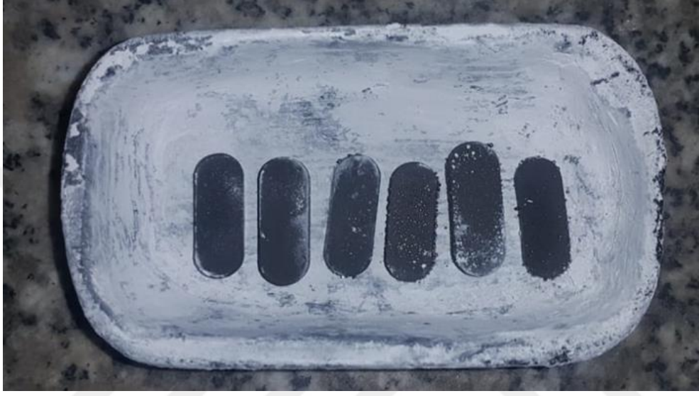
Şekil 4.16. İkinci gruptaki numunelerin sinter sonrası görüntüleri. Soldan sağa doğru sırasıyla S40 1-1 (40TA), S40 1-2 (40-30TA), S40 1-3 (40-30TA), kuru olarak tekrar öğütülmüş), S25 1-1 (25TA), S10 1-1 (10TA), S10 1-2 (10-5TA), kuru olarak tekrar öğütülmüş), numaralı numuneler. S25 4-1 (25TA) numaralı numune ayrı olarak sinterlenmiştir fakat sinterleme parametreleri bu sinter grubuyla aynıdır
