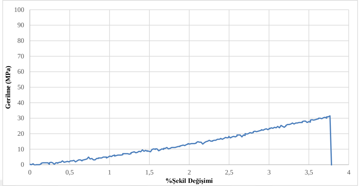
Şekil 4.34. S40 1-1 (40TA, 2 sö, %4 PEG, 1375°C 1 sa) numaralı numunenin gerilme - %şekil değişimi grafiği
