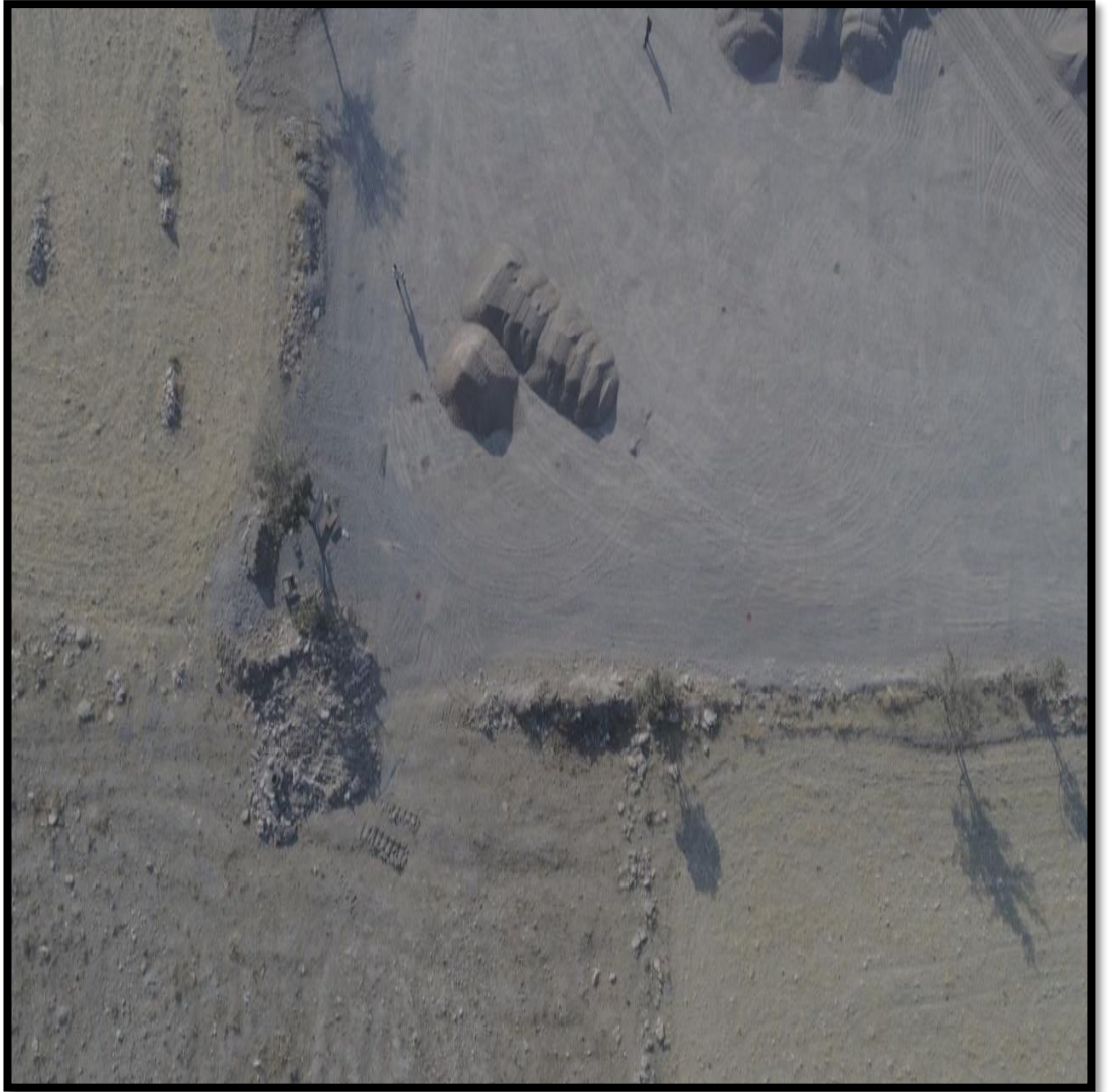
Şekil 5.40. Hacmi hesaplanacak malzemenin iha ile elde edilen fotoğraf örneği.
