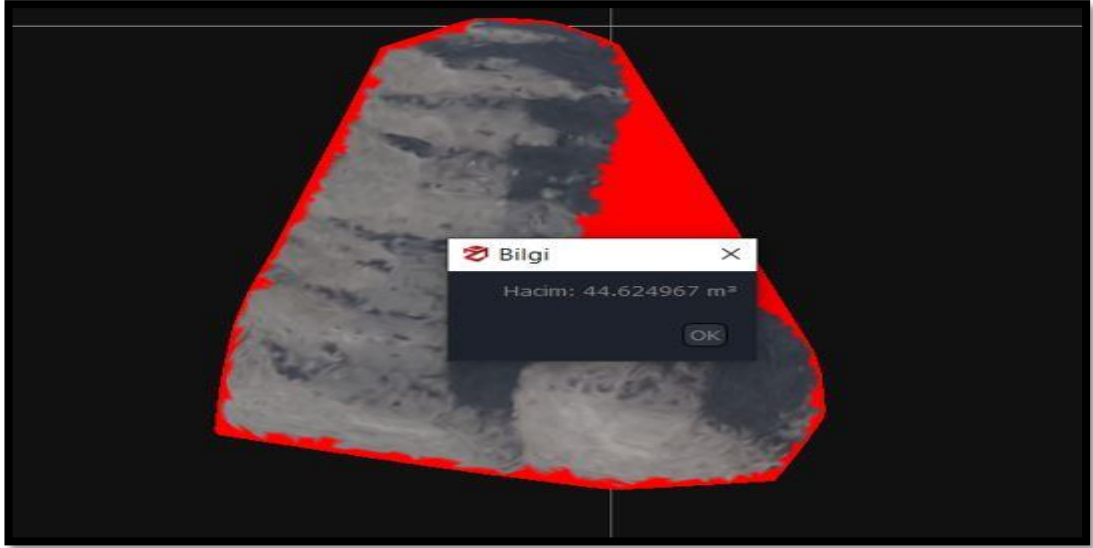
Şekil 5.82. 3DF zephyr programında gerçekleştirilen hacim hesabı sonuç ekranı.
