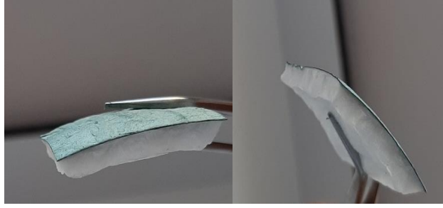
Şekil 4.3. Liyofilizasyon sonrası PCL/PANI+DCM kalıptan çıkarılmış haldeki görüntüsü
