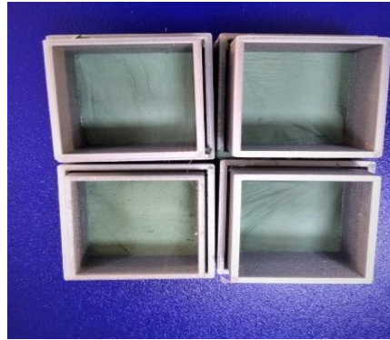
Şekil 3.1. 3B yazıcı teknolojisi ile üretilmiş kalıpların içerisine yerleştirilen PCL/PANI nanofiber membranlar
