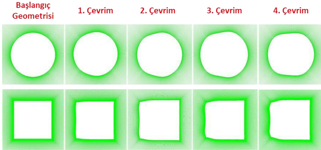
Şekil 2.10. İki şekle uygulanan adjoint geometrik optimizasyon çevrimleri sonucu elde edilen geometriler
