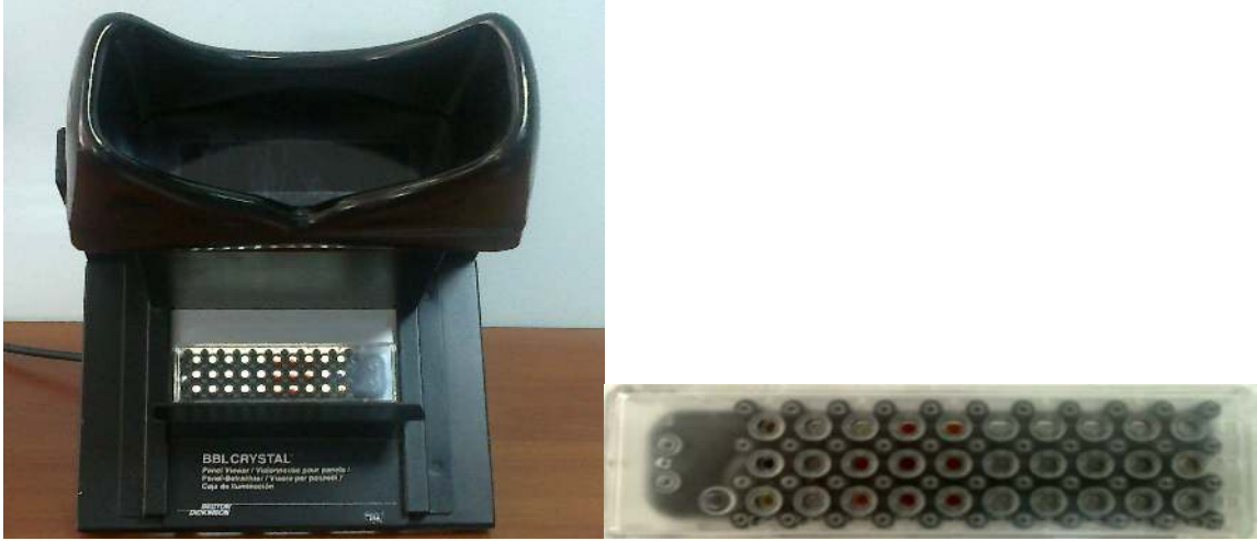
Resim 1. BBL Crystal N/H ID tanımlama paneli ve floresansı değerlendirme cihazı
