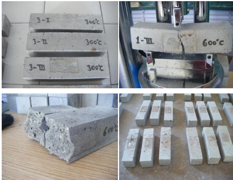
Şekil 4.15 300, 600 ve 900^{\circ}\text{C} sıcaklıklara maruz kalmış harç numuneleri
