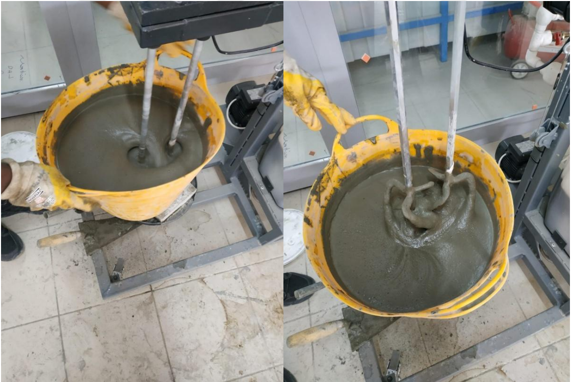
Şekil 4.8. Köpük ilavesi yapılan harç karışımının mikserle karıştırılması işlemi
