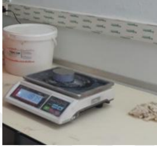
Şekil 4.14. Silindirik kap yardımıyla taze harç birim hacim ağırlıklarının ölçümü
