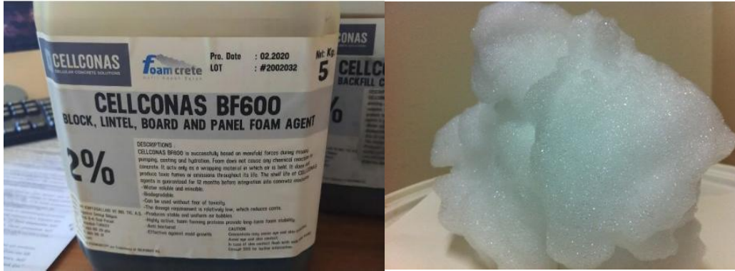
Şekil 3.3. Köpük ajanı solüsyonu ve elde edilmiş köpük
