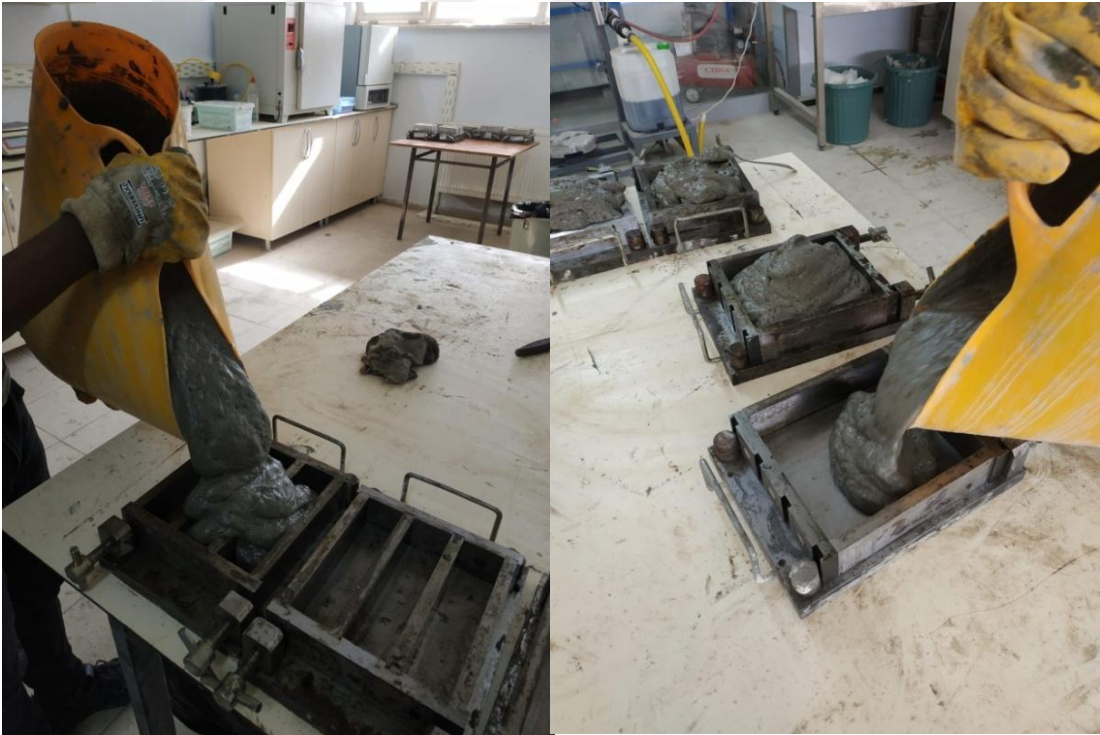
Şekil 4.10. Hazırlanan harç karışımının yağlanmış olan numune kalıplarına dökülmesi
