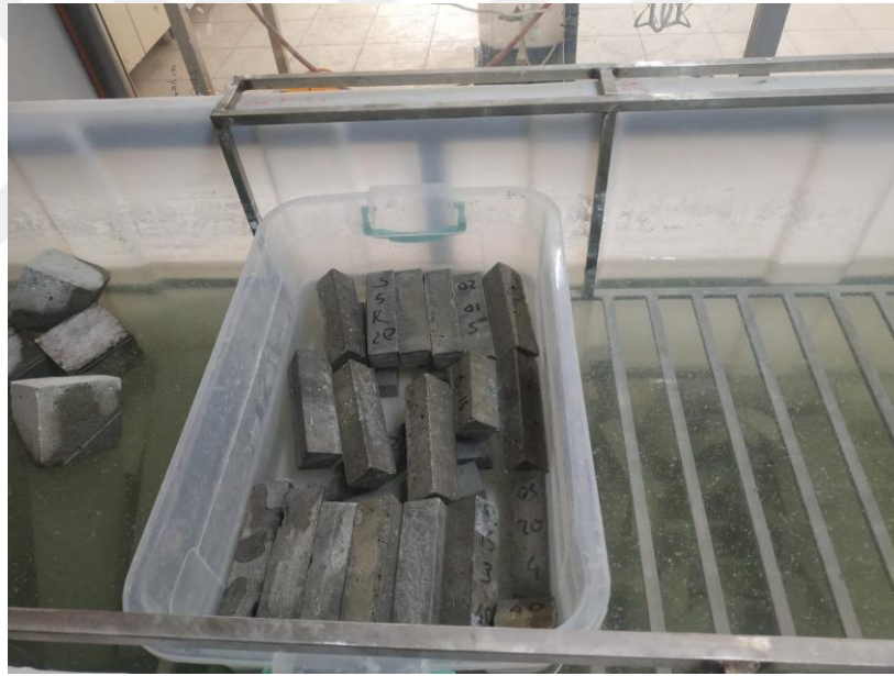
Şekil 4.16. 24 saat suda bekletilen ZKHB numuneleri
