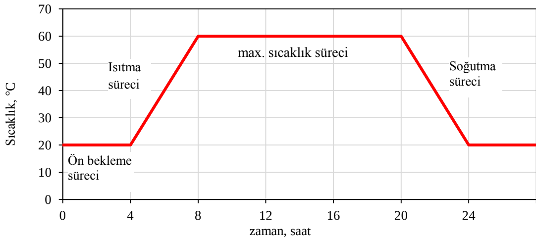
Şekil 4.4. Basınçsız sıcak buhar kürü çevrimi
