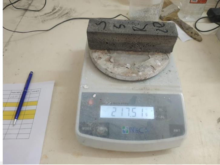
Şekil 4.17. ZKHB numunelerinin suya doymuş ağırlıklarının ölçümü
