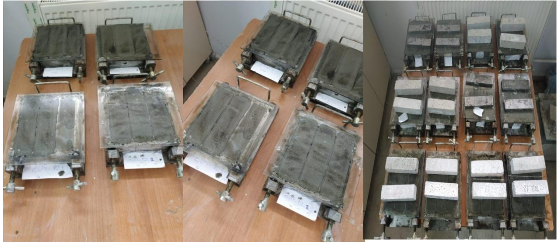
Şekil 4.12. Numune yüzeylerinin yağlanmış camla kaplanması
